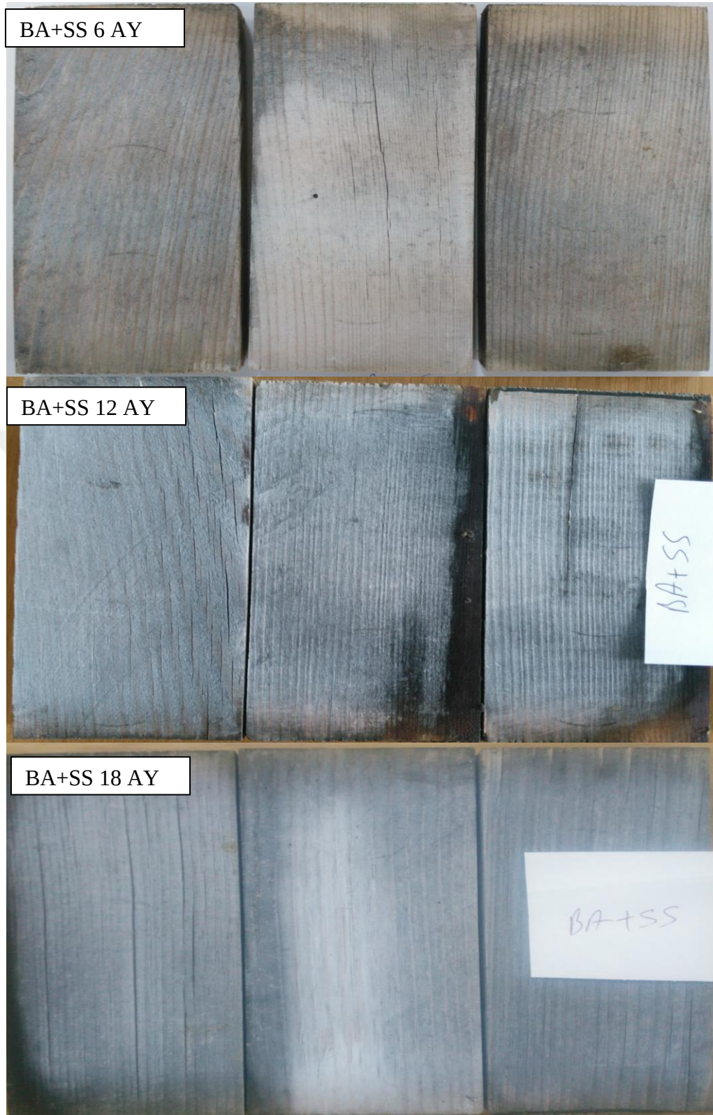
EK L: 6-12-18 ay dış ortam koşullarında beklemiş BA+SS emprenyeli örneklere ait görüntüler.
