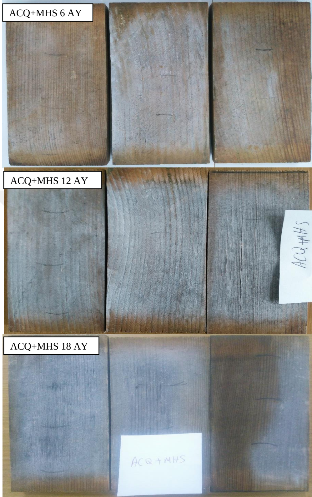
EK G: 6-12-18 ay dış ortam koşullarında beklemiş ACQ+MHS emprenyeli örneklerle ait görüntüler.
