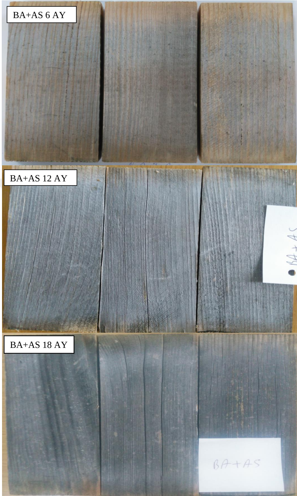
EK N: 6-12-18 ay dış ortam koşullarında beklemiş BA+AS emprenyeli örneklere ait görüntüler.
