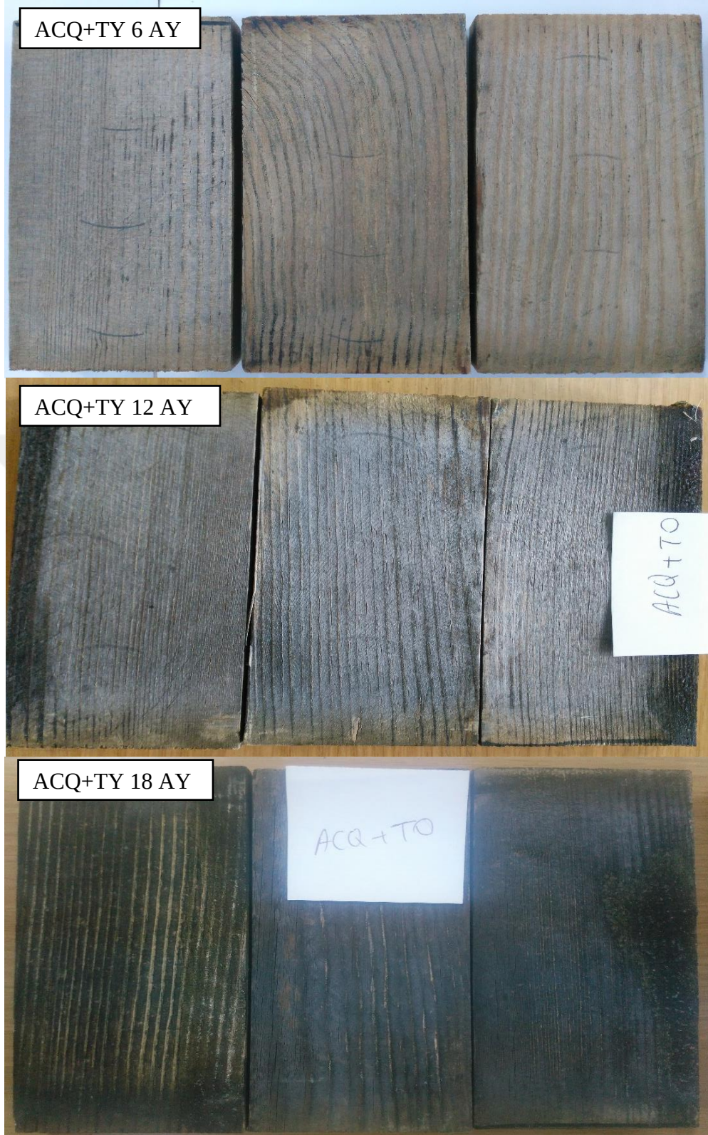
EK C: 6-12-18 ay dış ortam koşullarında beklemiş ACQ+TY emprenyeli örnekler ait görüntüler.
