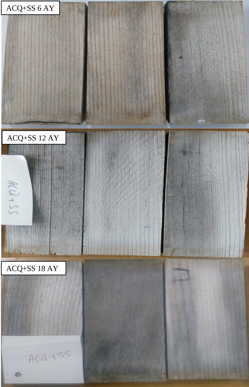
EK D: 6-12-18 ay dış ortam koşullarında beklemiş ACQ+SS emprenyeli örneklere ait görüntüler.
