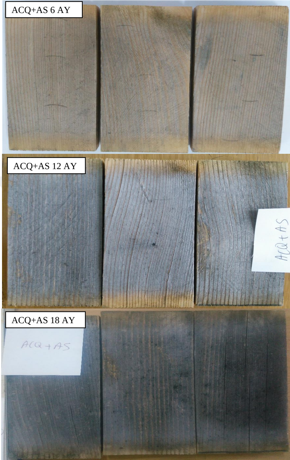
EK F: 6-12-18 ay dış ortam koşullarında beklemiş ACQ+AS emprenyeli örneklerle ait görüntüler.
