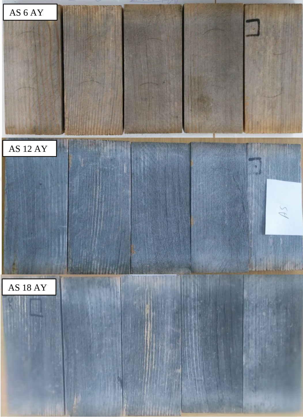
EK U: 6-12-18 ay dış ortam koşullarında beklemiş AS emprenyeli örneklere ait görüntüler.
