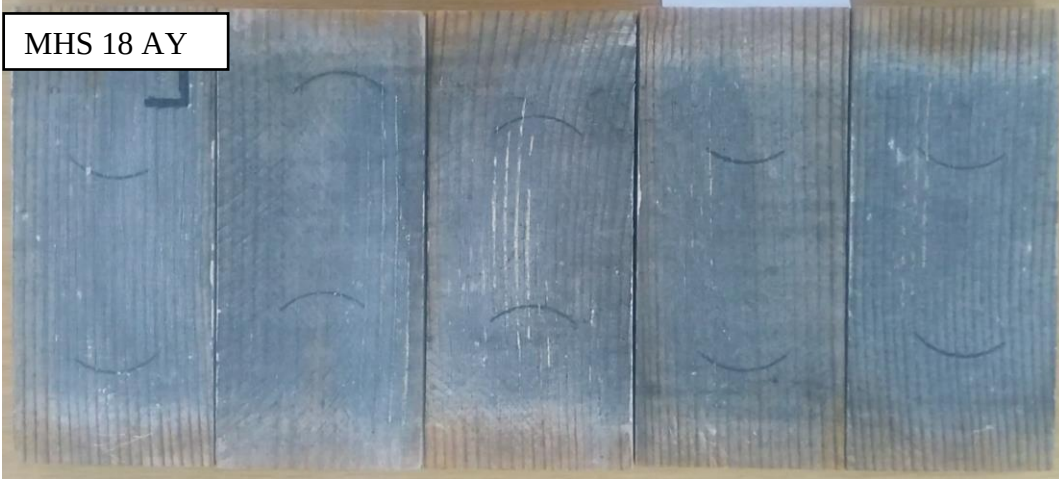
EK Ü: 6-12-18 ay dış ortam koşullarında beklemiş MHS emprenyeli örneklere ait görüntüler.
