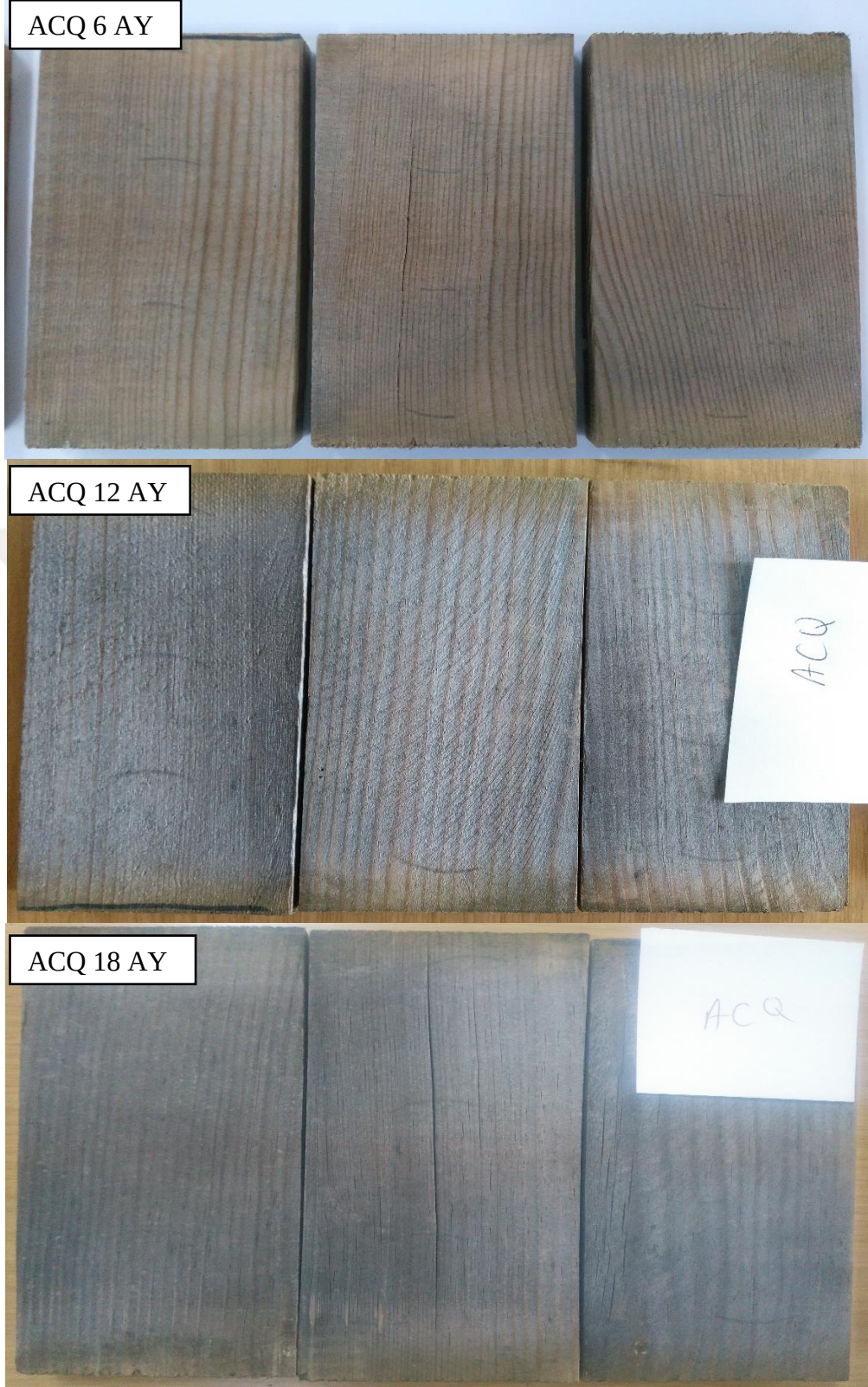
EK B: 6-12-18 ay dış ortam koşullarında beklemiş ACQ emprenyeli örneklere ait görüntüler.
