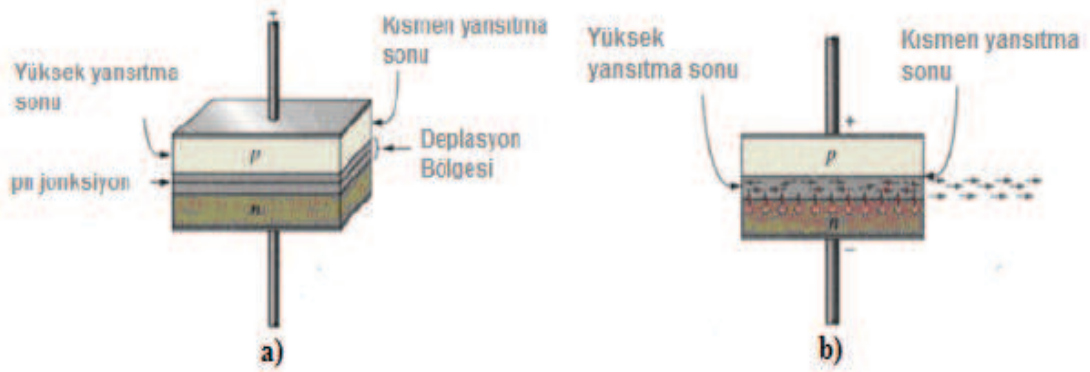
Şekil 2.4. Yarı iletken lazer; a) Yarı iletken lazer görünümü, b) Lazer oluşumu [11]
