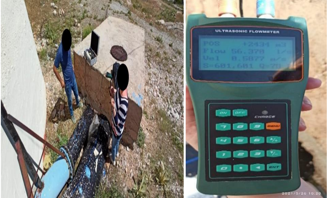
Şekil 4.6.Kızılcaoba deposu ultrasonic portatif debimetre ile debi ölçümü
