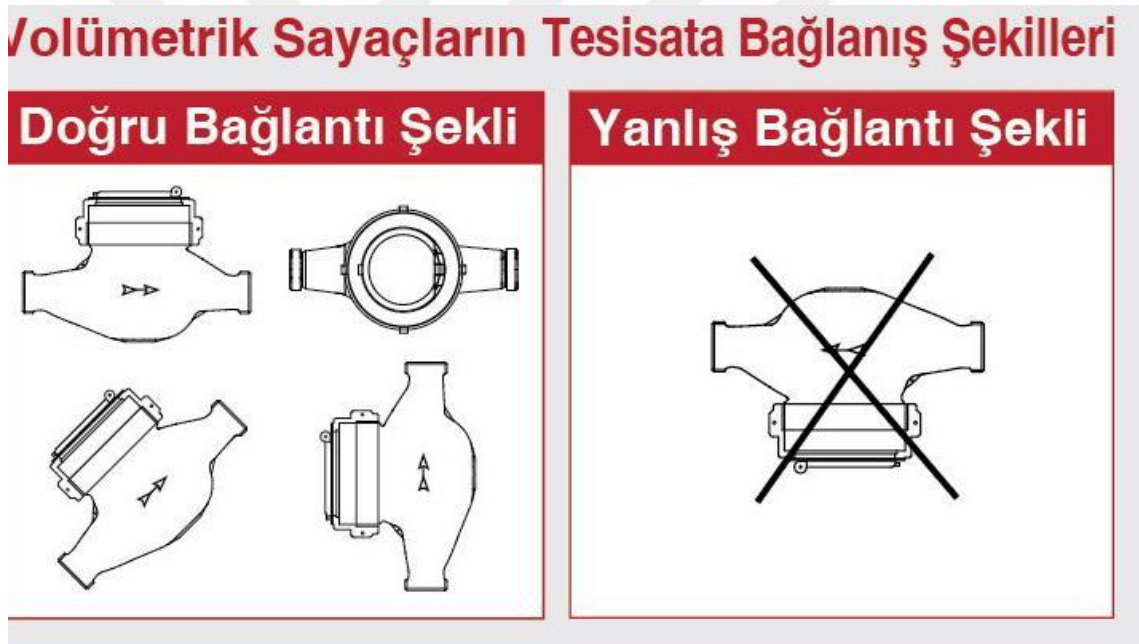
Şekil 4.12. Volümetrik sayaçların tesisata bağlantı şekilleri
