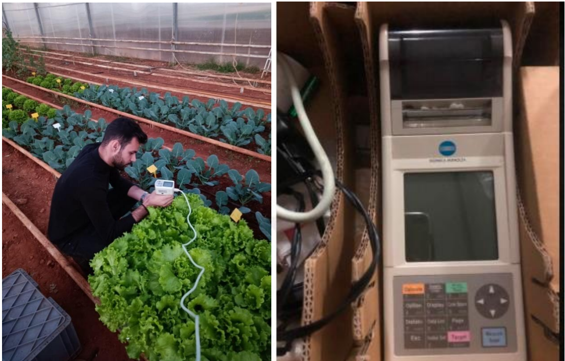
Şekil 3.19. Marul Yapraklarında renk ölçümü
