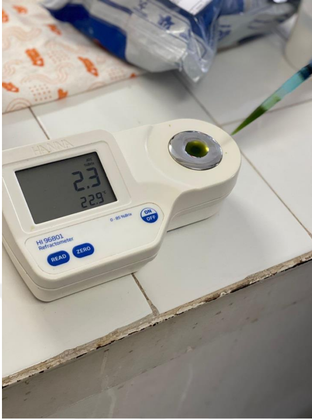
Şekil 3.12. Dijital refraktometre yardımıyla SÇKM ölçümü
