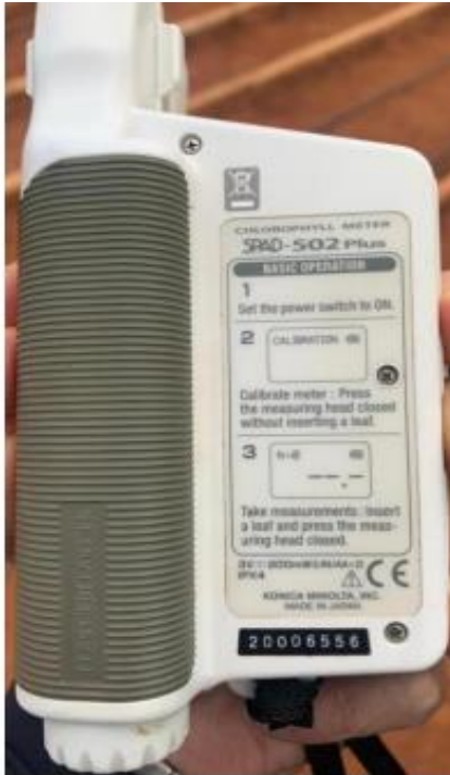
Şekil 3.18. Marul Yapraklarında klorofil ölçümü (SPAD-502 Plus)
