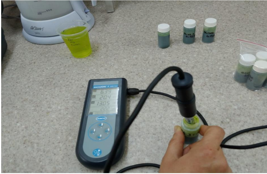
Şekil 3.12. Ispanak yapraklarında pH ve EC ölçümünden görüntü
