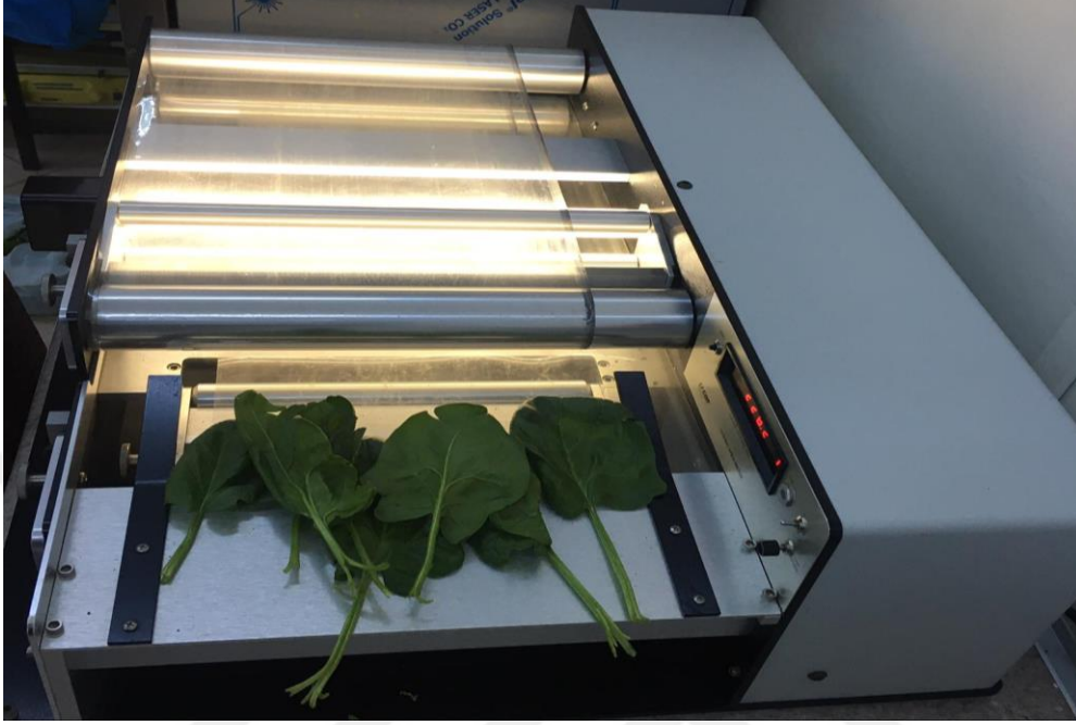
Şekil 3.9. Yaprak alan ölçer cihazı ile yaprak alanı ölçülmesi
