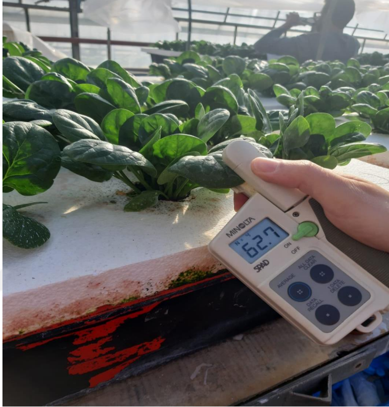
Şekil 3.11. Ispanak yapraklarında SPAD klorofil metre cihazı ile ölçüm yapılması
