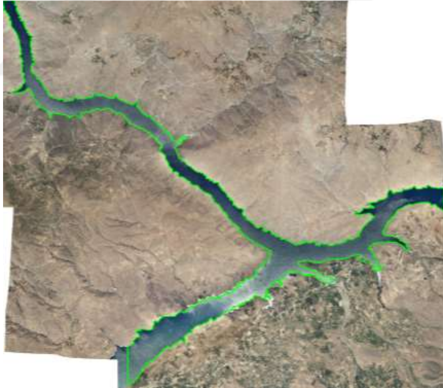
Şekil 54. Çalışma Alanı-2 sınıflandırma sonucu elde edilen su kütlesi sınırları
