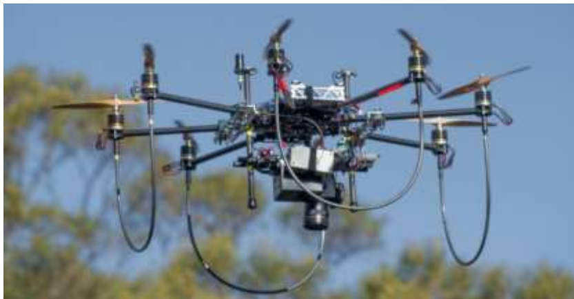
Şekil 3. RGB ve LiDAR algılayıcı taşıyabilen bir İHA platformu (Wallace vd., 2016)
