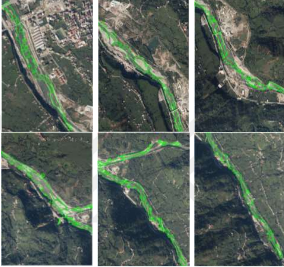
Şekil 53. Çalışma Alanı-1 Dere sınıflandırma sonucu elde edilen su kütlesi sınırları
