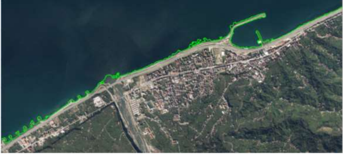
Şekil 52. Çalışma Alanı-1 Deniz sınıflandırma sonucu elde edilen su kütlesi sınırları
