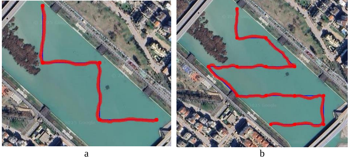
Şekil 4.8. Grid yöntemi koordinat seçimine göre yapılan denemelerde kuş uçuşu yol (mavi) ve İYA hareket yolu (kırmızı) a) Plan 3 rota; b) Plan 4 rota
