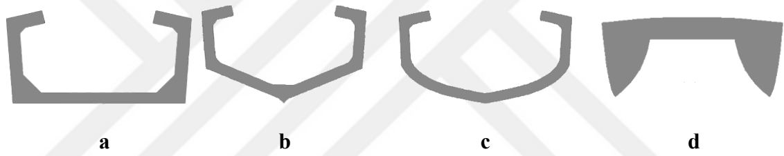
Şekil 2.2. İYA kabuk tasarımları a) Düz tabanlı; b) V-tabanlı; c) Yuvarlak tabanlı; d) Katamaran
