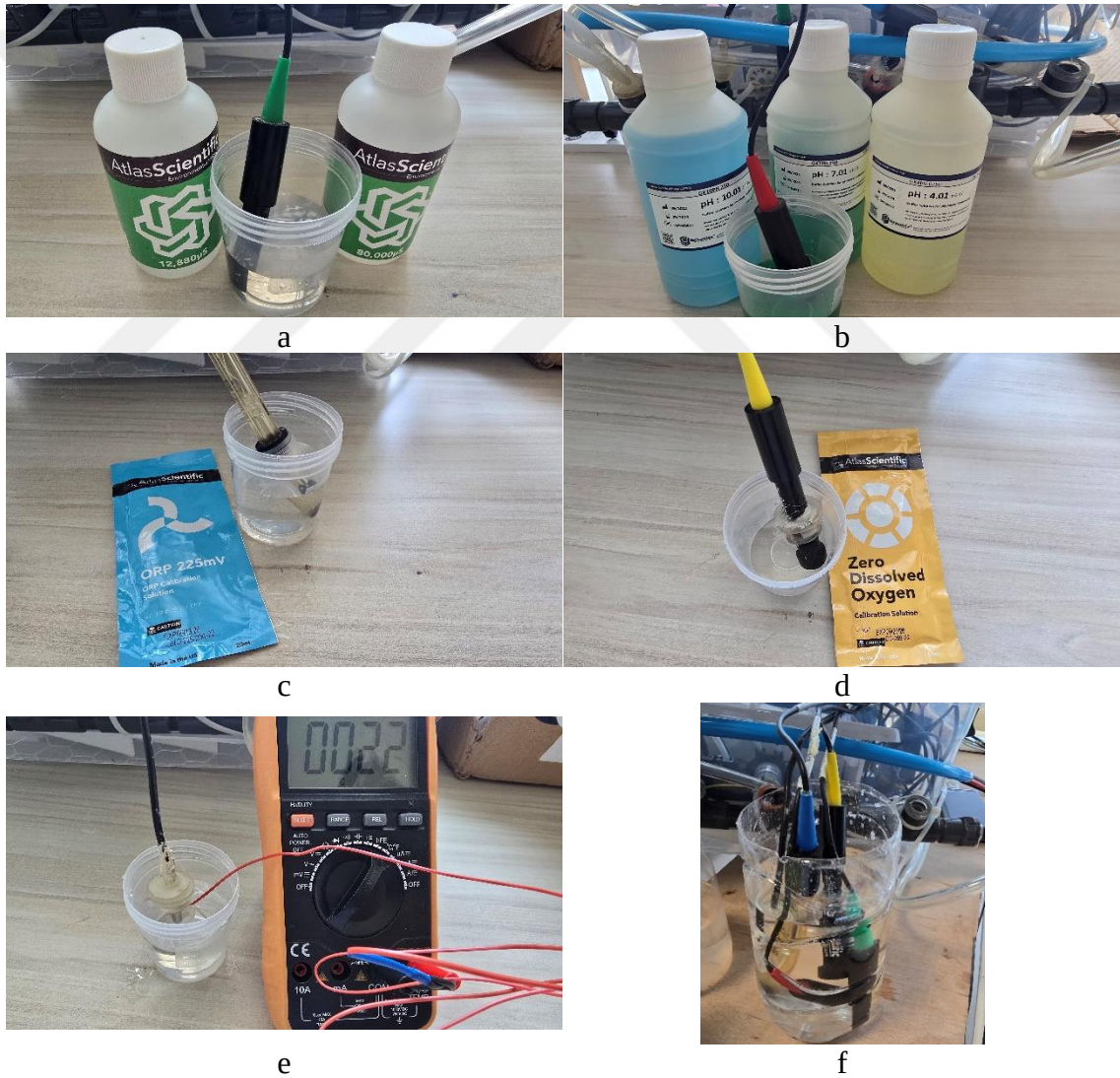
Şekil 3.12. Kalibrasyon işlemleri a) EC sensörü kalibrasyonu; b) pH sensörü kalibrasyonu; c) OPR sensörü kalibrasyonu; d) DO sensörü kalibrasyonu; e) Sıcaklık sensörü kalibrasyonu; f) Sensör temizleme
