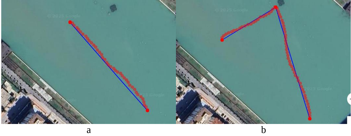
Şekil 4.5. Manuel koordinat seçimine göre yapılan denemelerde kuş uçuşu yolu (mavi) ve İYA hareket yolu (kırmızı) a) Plan1 rotası; b) Plan2 rotası
