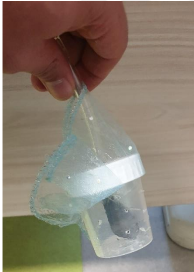
Şekil 3.8. Su parametreleri sistemi hortum başlığı
