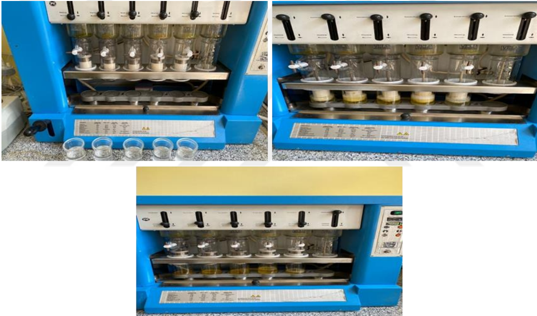
Şekil 17. Örneklerin yağlarının ekstraksiyonu (orijinal)
