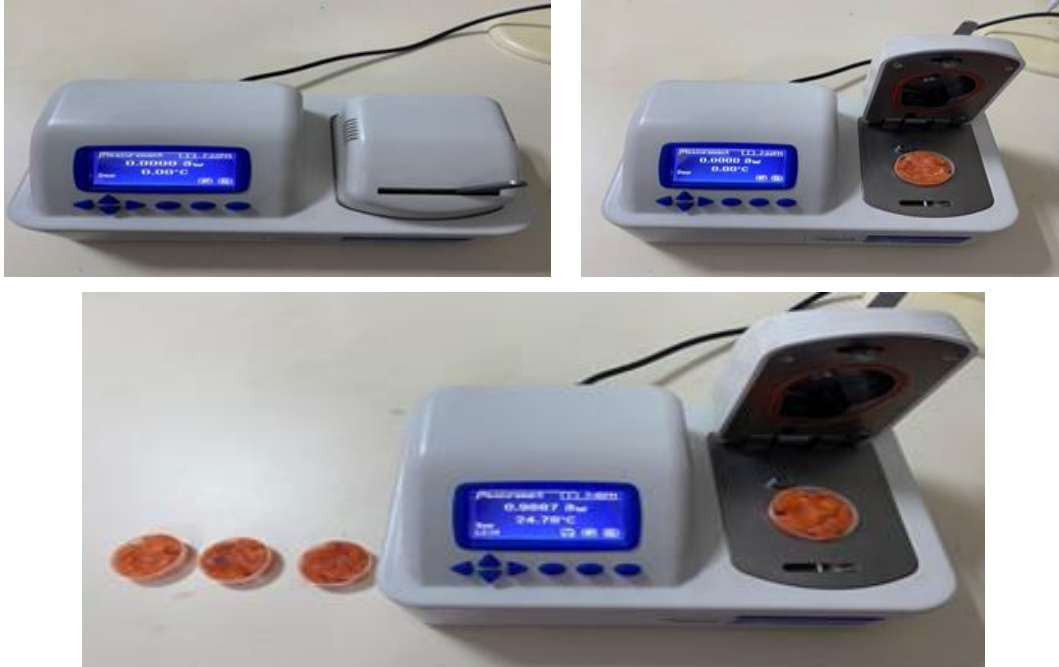
Şekil 11. Su aktivitesi ölçüm cihazı ile ölçüm aşamaları (orijinal)
