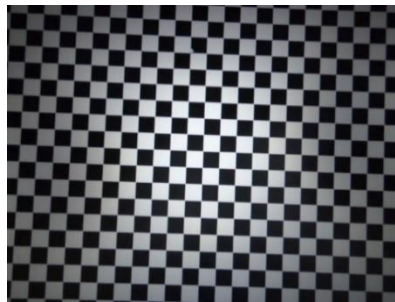
Figür 17: Kalibrasyon işlemi için satranç tahtasının görünümü.
