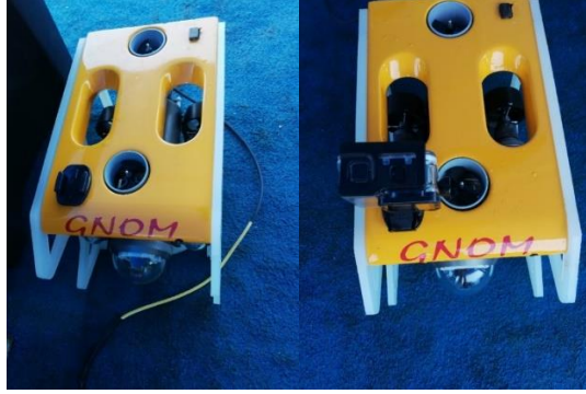
Figür 81a, b: Görüntüleme için kullanılan ROV ve üzerine yerleştirilmiş GoPro aksiyon kamerası.
