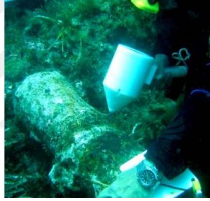
Resim 1.9: In situ korozyon potansiyeli analizi.
