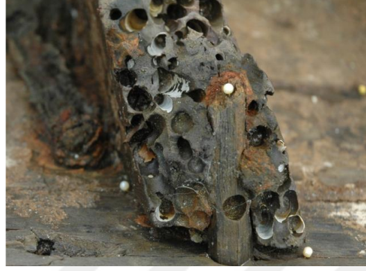
Resim 3.6: Yenikapı Batıkları Projesinde, YK12 ahşaplarında Teredo Navalis 'in neden olduğu fiziksel bozulmalar.
