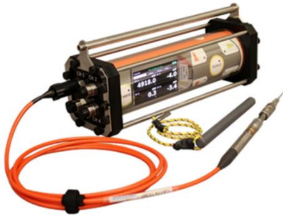
Resim 1.5: SASMAP Projesi kapsamında üretilen Unisense In situ kayıt cihazı.
