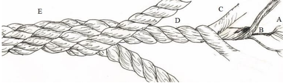
Şekil 3.4: Standart bir halatın yapı birimleri.
