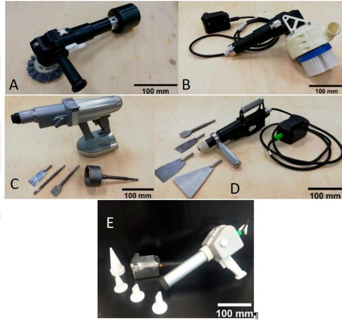
Resim 4.23: MaTaCos Projesi kapsamında üretilen, in situ temizlik ve sağlamlaştırmada kullanılan araçlar. (A) Şarjlı fırça, (B) değiştirilebilir başlıklı temizleyici, (C) Şarjlı darbeli matkap, (D) Ucu değiştirilebilir temizlik aracı, (E) Enjeksiyon aracı.
