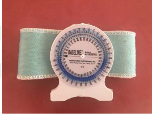
Şekil 11: Omuz Pozisyon Duyusu Ölçümü İçin Hazırlanan Su kontrollü İnklinometre Düzenegi
