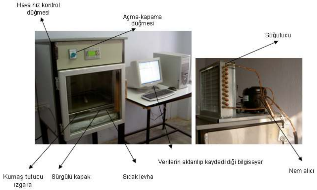
Şekil 2.2 Dinamik Terleyen Levha Sistemi (Kaplan ve Okur, 2010)
