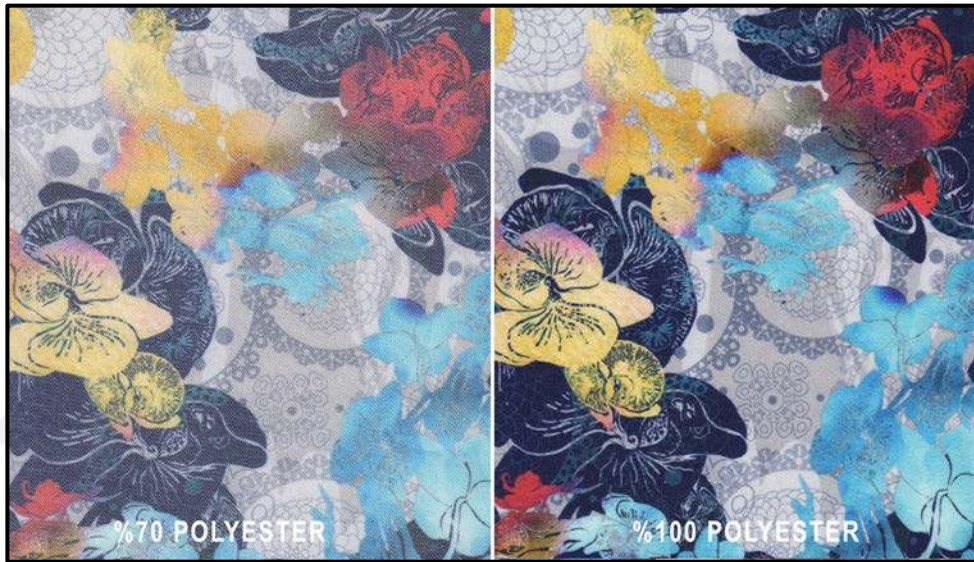
Fotoğraf 47: %70 ve %100 Polyester Oranındaki Kumaşların Yüzeyinde Oluşan Baskı Sonuçlarından Kesitler
