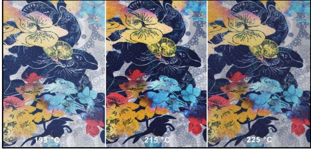
Fotoğraf 40: 195°C- 215°C- 225°C Transfer Sıcaklıkları ile Oluşan Baskı Sonuçlarından Kesitler
