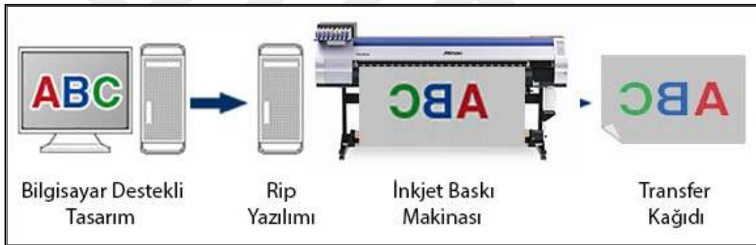
Şekil 25: Transfer Kağıdına işlem sırlaması ve Kağıt üzerindeki Tasarım
