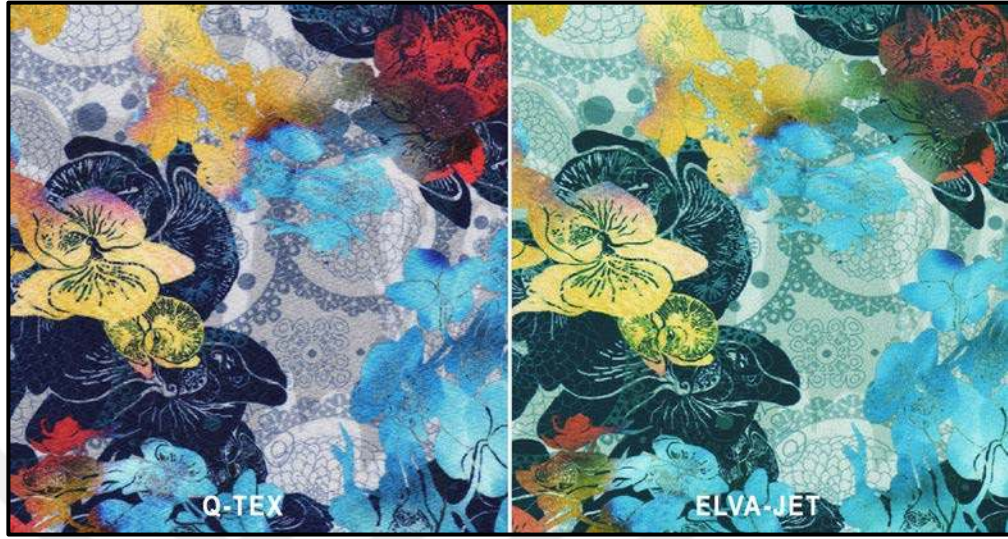
Fotoğraf 30: Q-tex ve Elva-jet Mürekkebi ile Oluşan Baskı Sonuçlarından Kesitler
