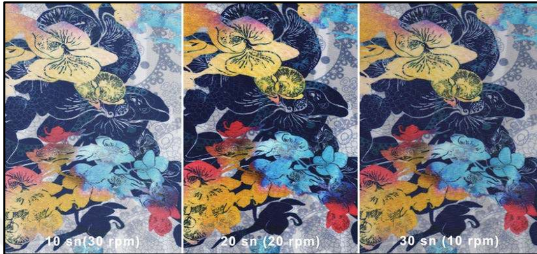
Fotoğraf 44: 10 sn (30 rpm), 20 sn (20 rpm), 30 sn (10 rpm) Transfer Süreleri ile Oluşan Baskılardan Kesitler
