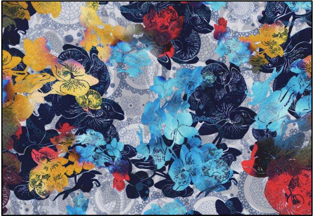
Fotoğraf 38: 215 °C Transfer Sıcaklığı ile Oluşan Baskı Sonucu
