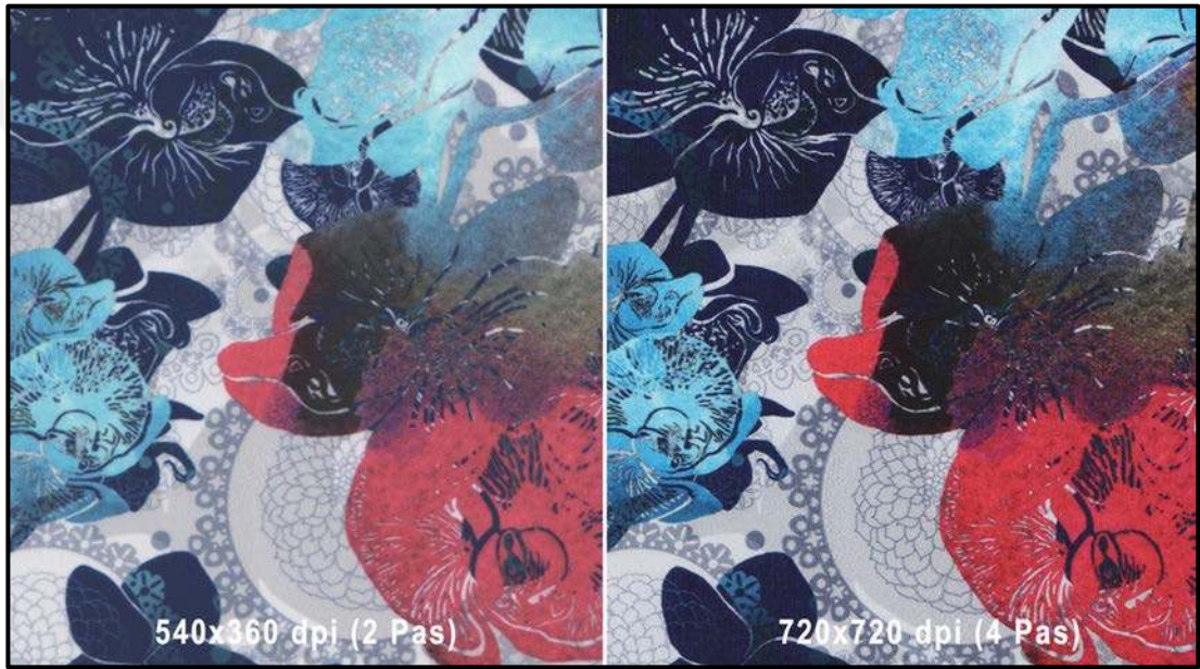
Fotoğraf 22: 540x360 dpi ve 720x720 dpi Baskı Çözünürlükleri ile Oluşan Baskı Sonuçlarından Kesitler
