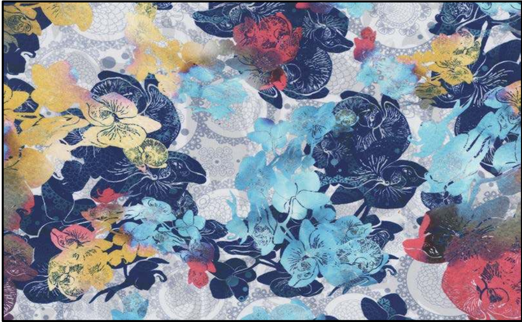
Fotoğraf 41: 10 sn (30 rpm) Transfer Hızı ile Oluşan Baskı Sonucu
