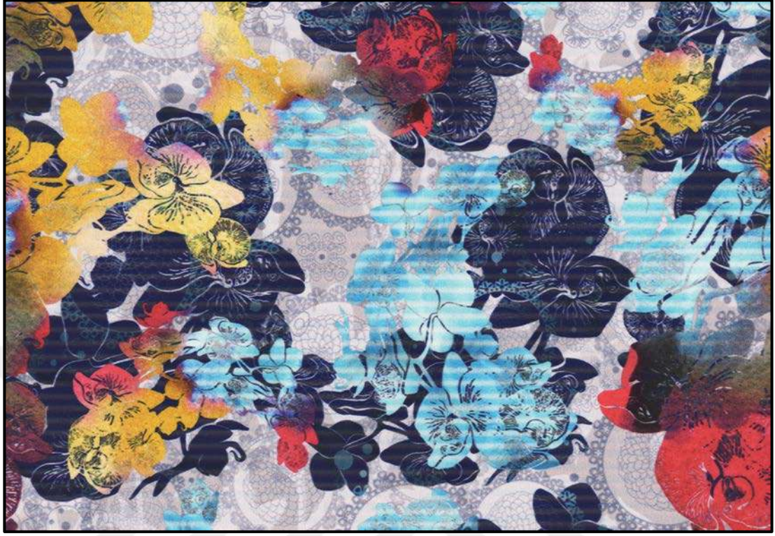
Fotoğraf 26: Tıkalı Nozzle ile Oluşan Baskı Sonucu
