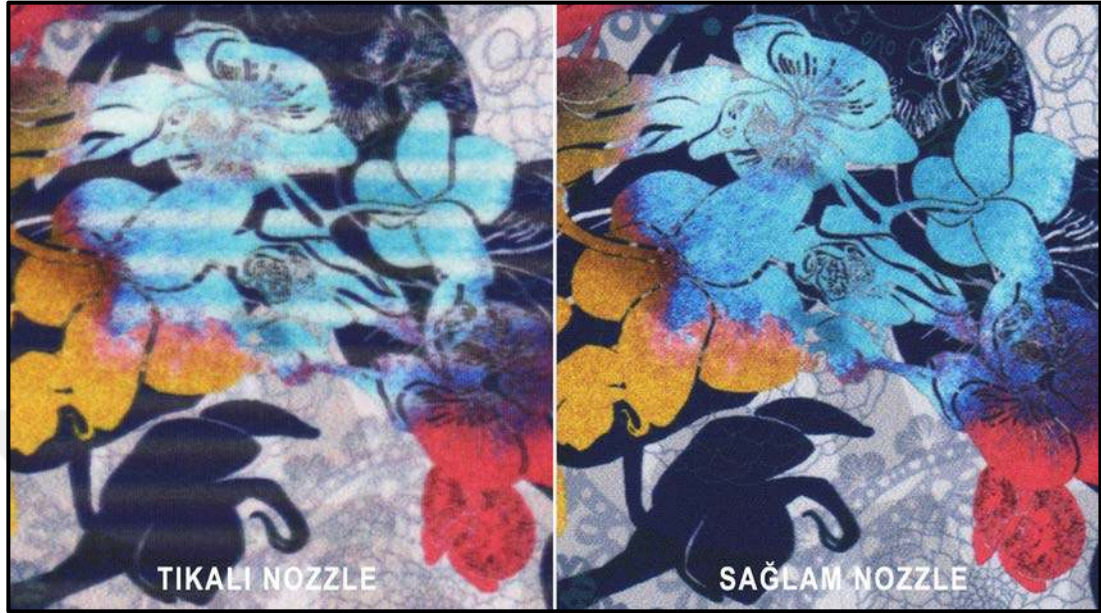
Fotoğraf 27: Tıkalı Nozzle ve Sağlam Nozzle ile Oluşan Baskı Sonucundan Kesitler
