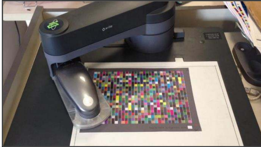
Fotoğraf 4: X-rite İO Spektrofotometre ile ECI 2002 CMYK Skalasını Okutma İşlemi
