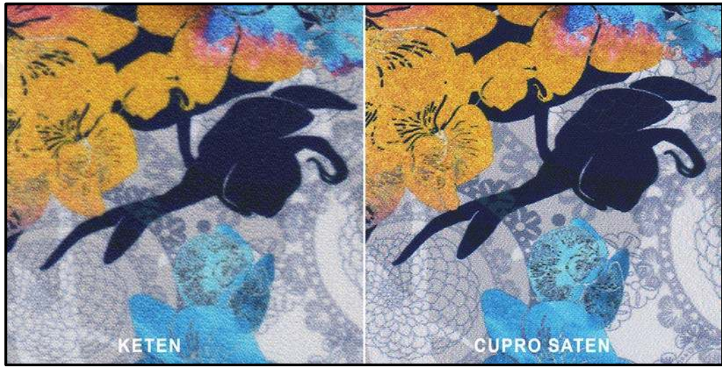
Fotoğraf 50: Saten-Keten Görünümlü Polyester Tekstil Kumaşları ile Oluşan Baskı Sonuçlarından Kesitler
