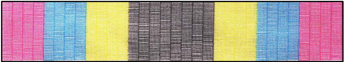
Fotoğraf 23: Tıkanmamış Nozzle Görüntüsü
