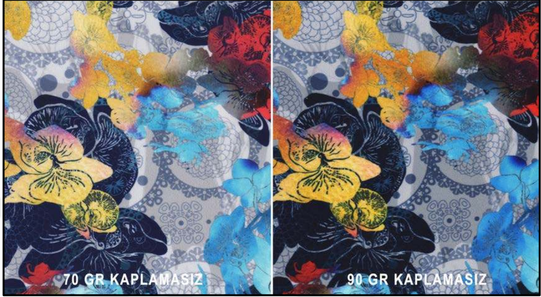
Fotoğraf 33: 70 gr ve 90 gr Kaplamasız Transfer Kağıtları ile Oluşan Baskı Sonuçlarından Kesitler
