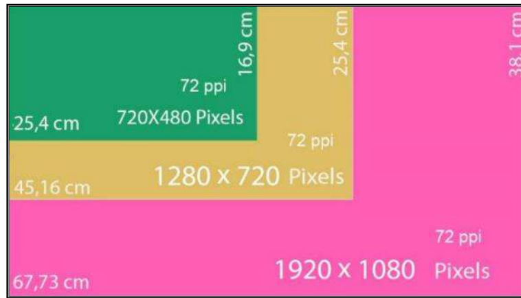
Şekil 3: 72 PPI Pixel Yoğunluğundaki Farklı Çözünürlüklerin Baskı Boyut Ölçüleri
