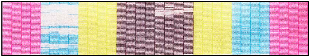
Fotoğraf 25: Tıkanmış Nozzle Görüntüsü
