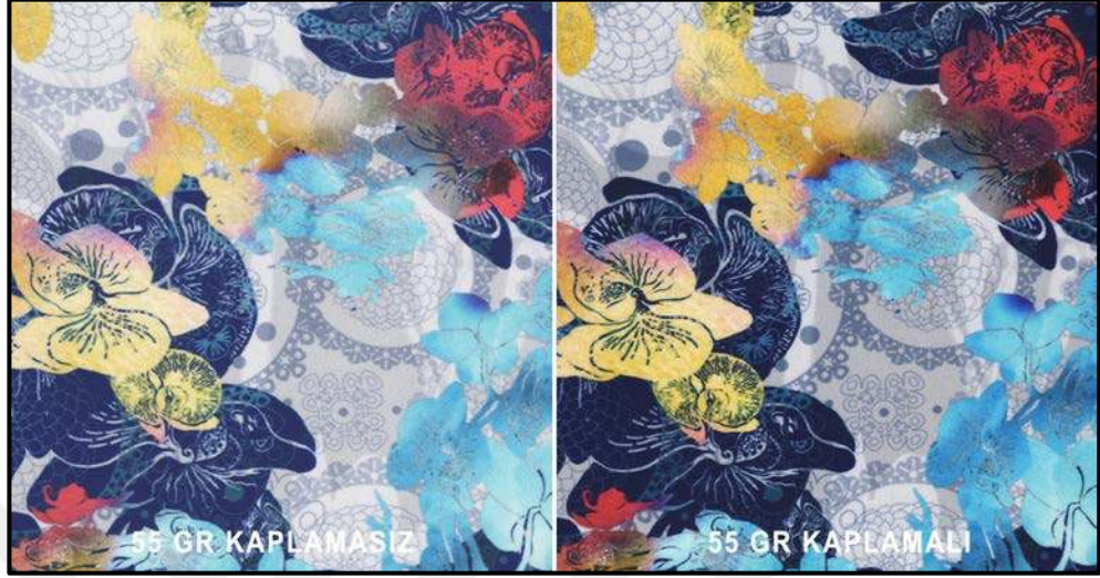
Fotoğraf 36: 55 gr Kaplamalı ve 55 gr Kaplamasız Transfer Kağıtları ile Oluşan Baskı Sonuçundan Kesitler
