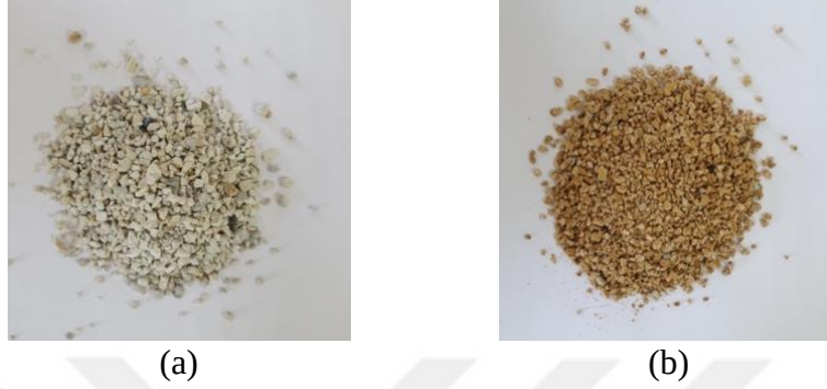
Şekil 4.26. (a) TZE doğal malzemesi, (b) TZE-DO modifiye kolon malzemesi
