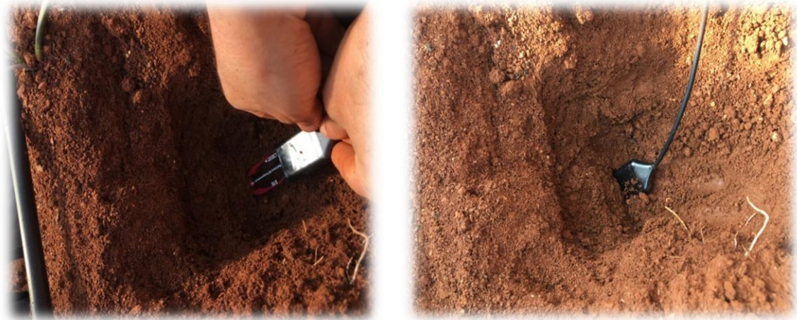
Şekil 3.3. Toprak su içeriği ölçüm sensörlerinin deneme parseline yerleştirilmesi
