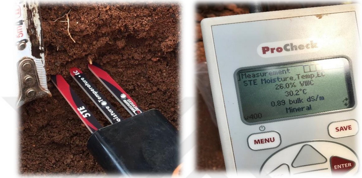
Şekil 3.5. Decagon 5TE cihazı ve problelerinin toprağa yerleştirilmesi
