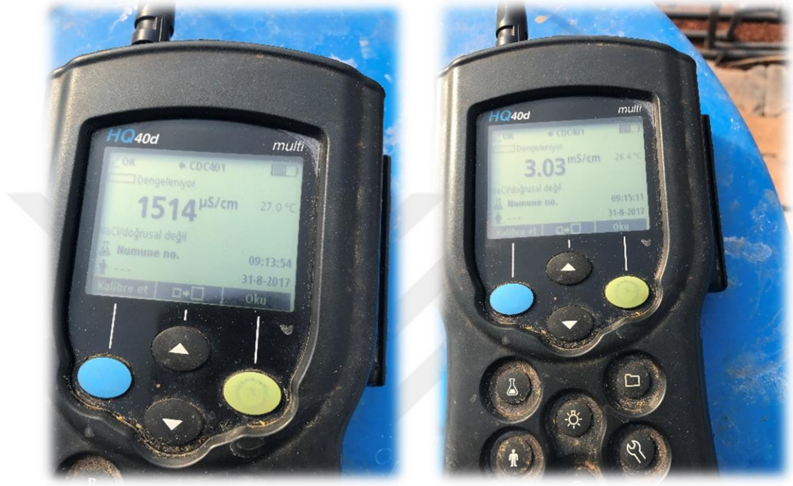
Şekil 3.7. Depolara tuzun eklenmesinden sonra sulama sularının elektriksel iletkenlik değerlerinin kontrol edilmesi
