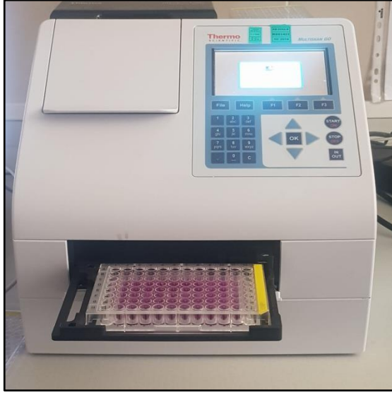
Resim 3.8. Pleytin mikropate spektrofotometrede ölçülmesi
