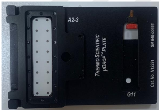
Resim 4.1. Nanodrop cihazı ile RNA konsantrasyonu ölçümü
