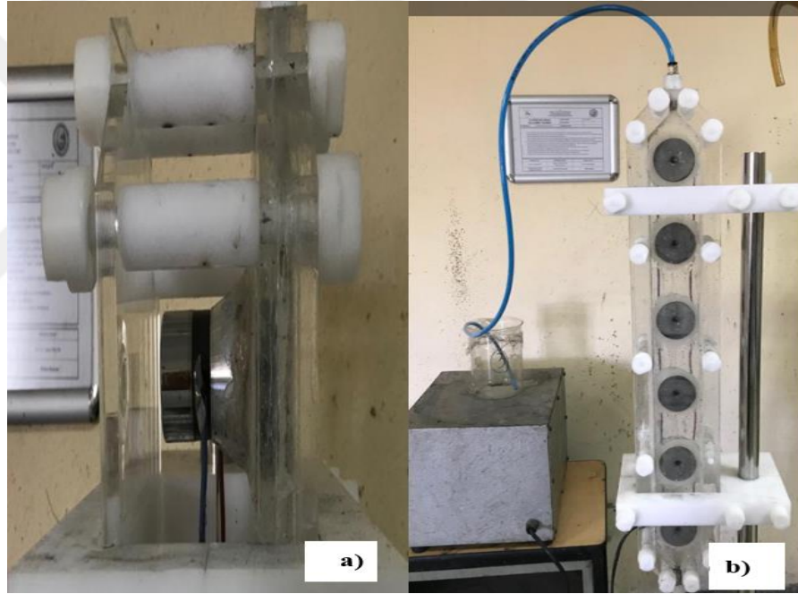
Şekil 3.52 Ultrasonik başlıklar ve montajı (a: Tek başlık b: Test düzeniğinin ön görüntüsü) (Kişisel arşiv, 2021)
