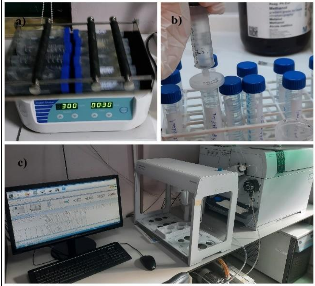
Şekil 3.5 a) Orbital çalkalayıcıda karıştırma işlemi b) Filtreleme işlemi c) ICP-MS cihazında analiz işlemi.
