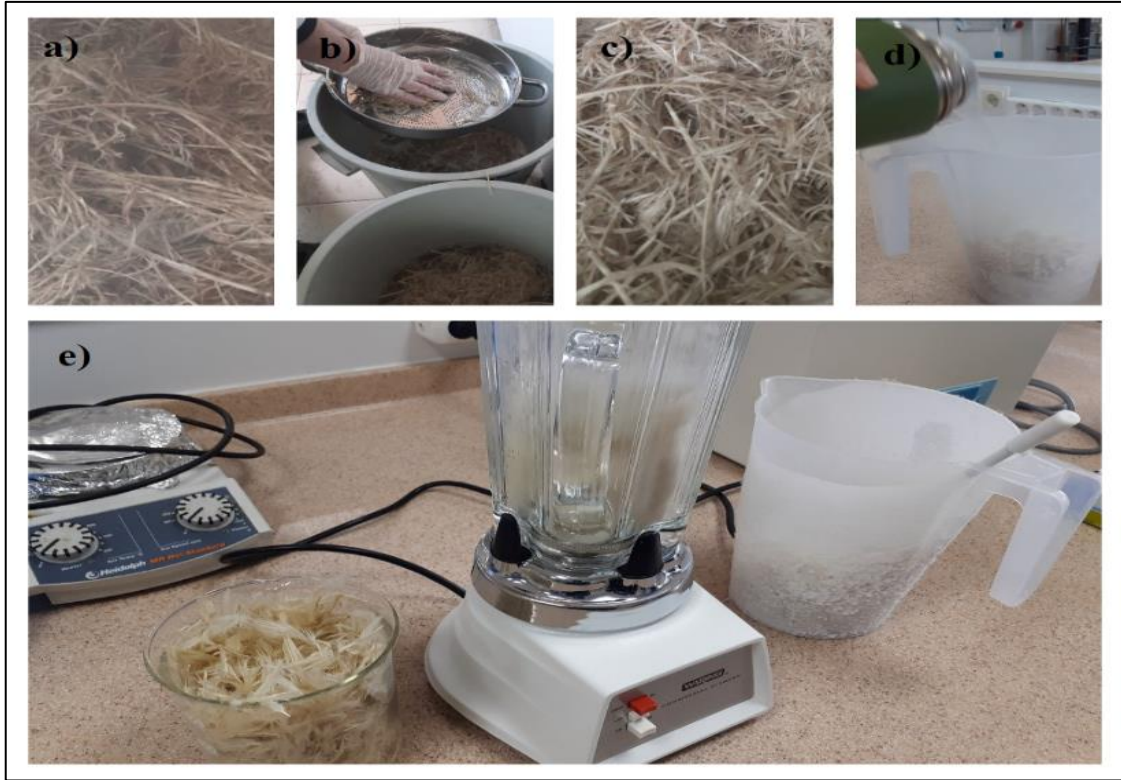
Şekil 3.1 a) Ön işlem öncesindeki tavuk tüyleri b) Safsızlık ve kirlerden arındırma işlemi c) Safsızlık ve kirlerden arındırılmış tavuk tüyleri d) Sıvı nitrojen ilavesi e) Blender ile parçalama işlemi.
