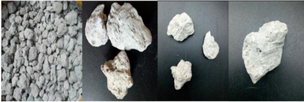
Şekil 4.3. Pomza taşının yapısı (Aregu, Asfaw, & Khan, 2018)
