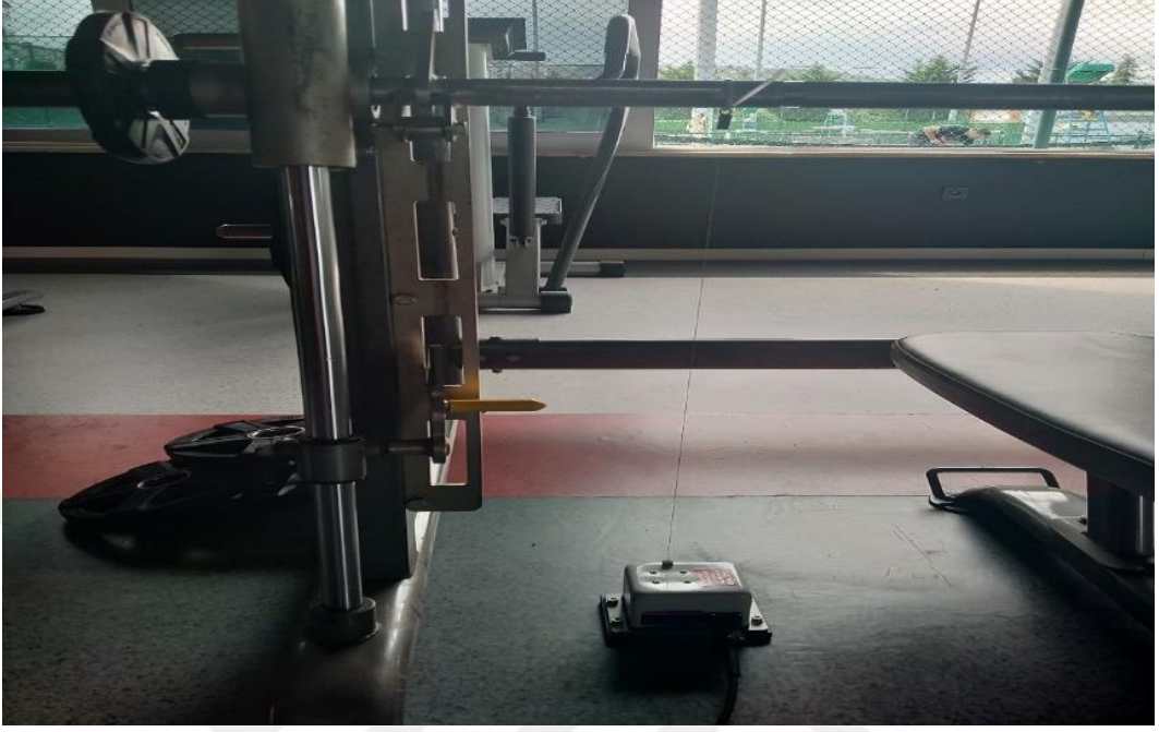
Şekil 29. T force elektronik beyin kutusu ve konumu
