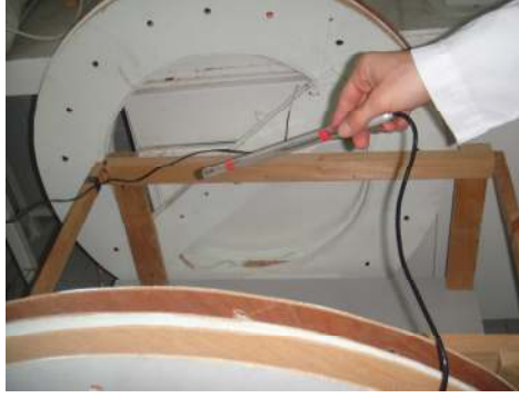
Resim 21: Kafes içerisindeki manyetik alan yoğunluğunun ölçülmesi
