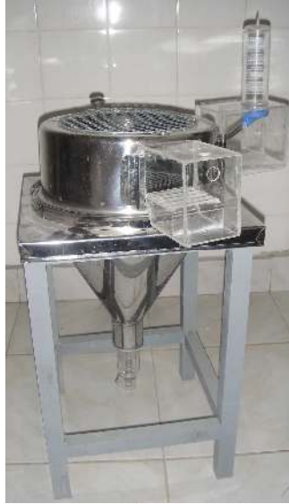
Resim 28: İdrar örneği elde etmek amacıyla kullanılan metabolik kafesin görünümü
