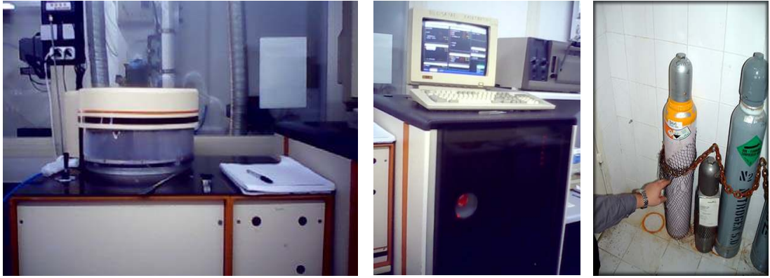
Resim 4.1. Sırasıyla PECVD cihazı, kullanılan bilgisayar ve depodaki gazlar
