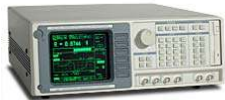
Resim 5.6. Kilitli yükselteç (Lambda Photometrics)
