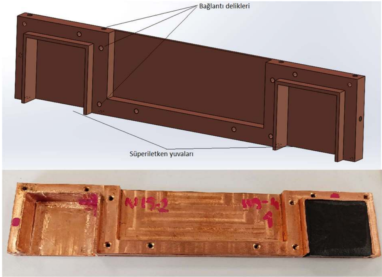
Şekil 3.3. Kriyostatın bakır tabanı. Bakırın yüksek ısı iletim katsayısı sayesinde yuvalardaki süperiletkenlerin sıvı azota direkt temas etmeden kritik sıcaklığa kadar soğutulması planlanmıştır. Şekilde parçanın teknik çizimi ve üretilen parça görülmektedir.
