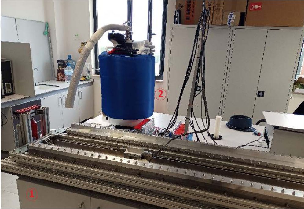
Şekil 4.1. Deney düzeneği. 1 numara ile gösterilen kısımda raylar ve lineer motor bulunmaktadır. 2 ile gösterilen ise sıvı azot tankıdır.
