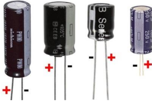
Şekil 1.4. Elektrolitik kondansatör
