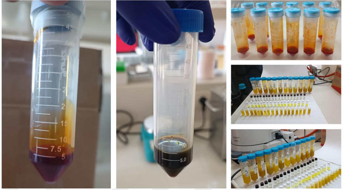
Şekil 3.5. Numunelerden elde edilen özütler ve HPLC analizi için örnek hazırlama aşamaları
