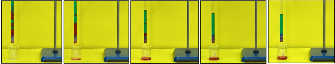
Şekil 4.34. Yerçekimi kuvvetine dayalı ayırma metodunun kullanılması ile kloroform-su karışımındaki kirleticinin MS/METES sorbent materyali tarafından seçimli bir şekilde giderilmesi prosesine ait fotoğraf görüntüleri.
