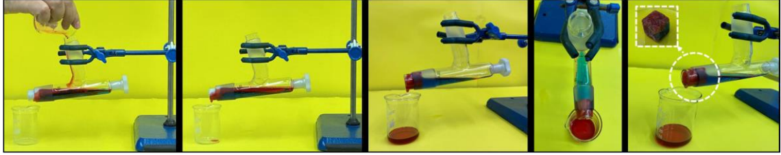
Şekil 4.33. Spontane ayırma metodunun kullanılması ile zeytinyağı-su karışımındaki kirleticinin MS/METES sorbent materyali tarafından seçimli bir şekilde giderilmesi prosesine ait fotoğraf görüntüleri.
