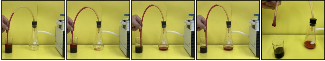
Şekil 4.35. Sürekli ayırma prosesi metodunun kullanılması ile mazot-su karışımındaki kirleticinin MS/METES sorbent materyali tarafından seçimli bir şekilde giderilmesi prosesine ait fotoğraf görüntüleri.
