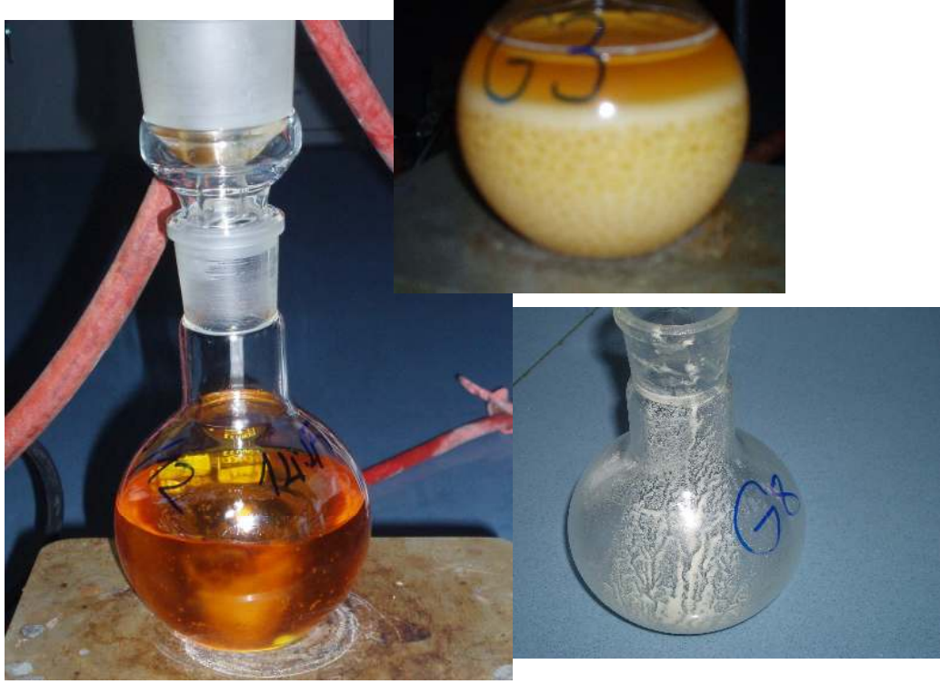
Şekil 5.3 Nötralizasyon aşaması ve tuz oluşumunun gözlenmesi
