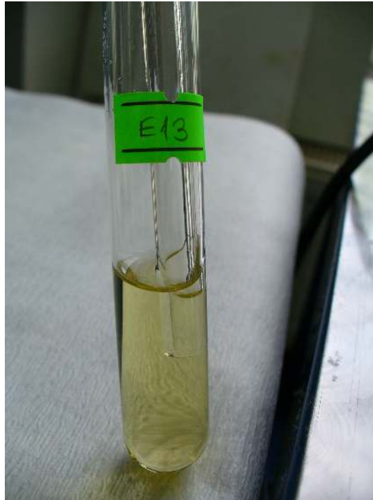
Şekil 5.17 Yüksek dönüşüm içeren bir biodizel üretim aşaması (tek faz)
