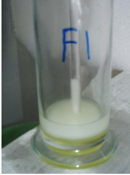
Şekil 5.16 Düşük dönüşüm içeren bir biodizel üretim aşaması (2 faz)
