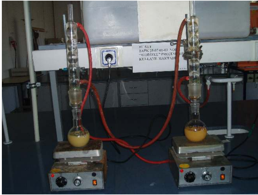
Şekil 5.1 Transesterifikasyon deney düzeneği
