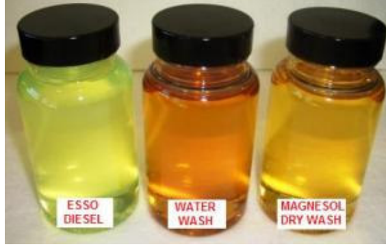
Şekil E4.1 Magnesol kullanılarak saflaştırılmış biodizel numunesindeki farklılık [11]
