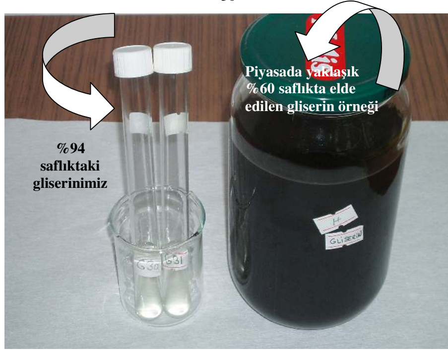
Şekil 5.6 Gliserin örneklerinin karşılaştırılması (Foto: Akgün, 2005)
