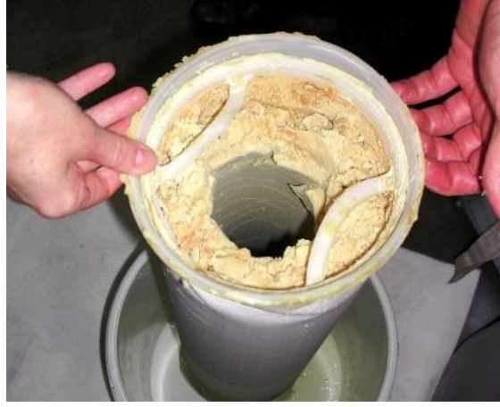
Şekil E4.2 Magnesol kullanımının ardından filtrede kalan biodizele ait safsızlıklar [11]
