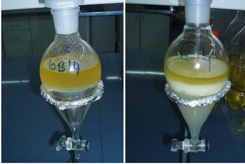
Şekil 5.5 Biodizel numunelerini yıkama aşaması
