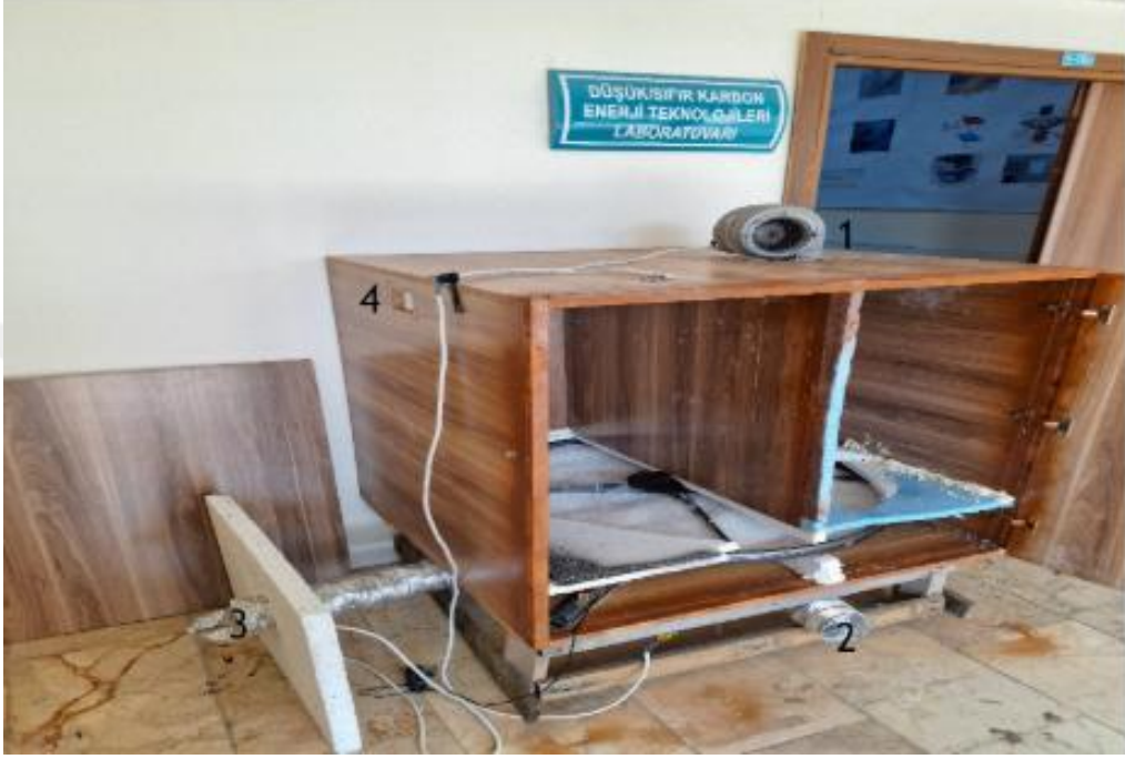
Şekil 7. Tez çalışması kapsamında tasarımı yapılarak prototip üretimi gerçekleştirilen döner kurutucu çark esaslı ilk nem alma sistemi
