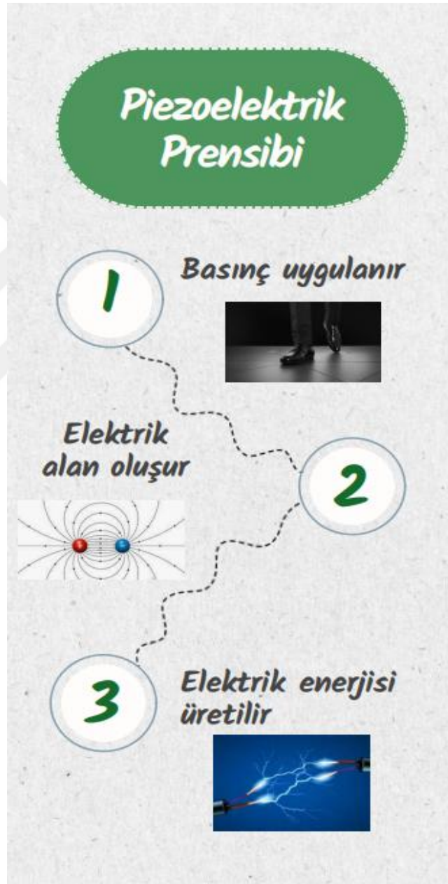
Şekil 3.6. Piezoelektrik Prensibi (Şekil yazar tarafından geliştirilmiştir)
