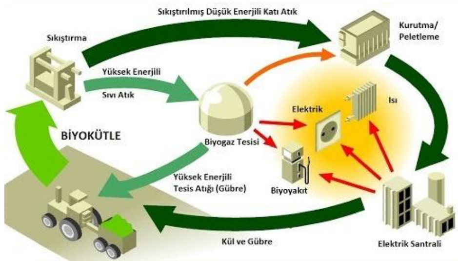
Şekil 2.5. Biyokütle Enerji Döngüsü (Anonim 2022f)
