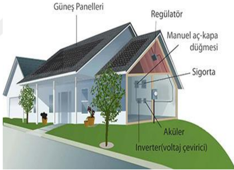
Şekil 8.2: Güneş Enerjisi Panel ve Ekipmanları ( http://www.goenerji.com.tr , 2018)
