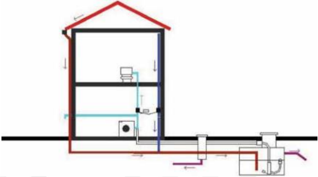
Şekil 4.5. Şebeke döşemenin yağmur suyu döşemini direkt beslemesi (Şahin ve Manioğlu, 2011).
