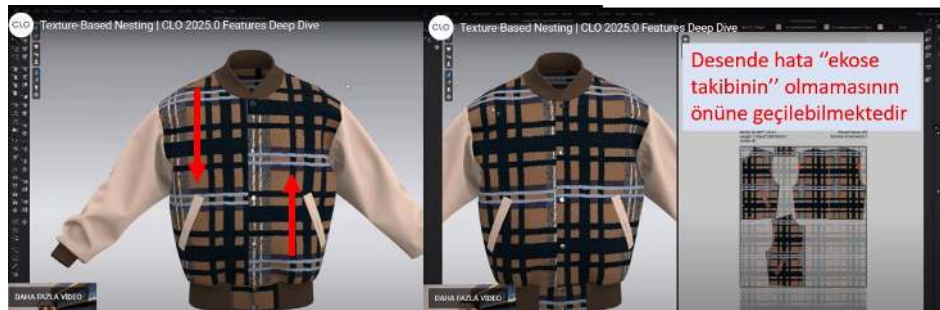
Şekil 29. CLO3D ile ekose gibi desenlerdeki kaymaların önlenmesi ve kalıp yerleşimlerinin sanal numunede kusursuz görünümünün sağlanması.
