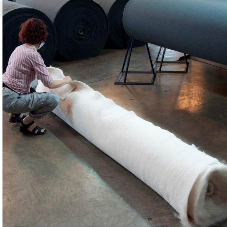
Görsel 19. Tabaka haline getirme: 5. Adım Kaynak: https://www.ananas-anam.com/about-us/
