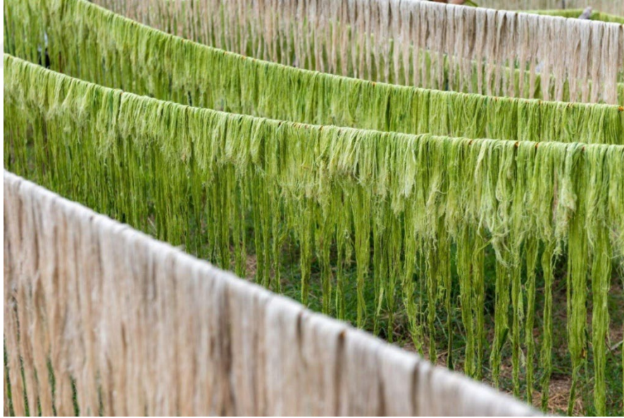
Görsel 17. Yıkama ve Kurutma: 3. Adım Kaynak: https://www.ananas-anam.com/about-us/
