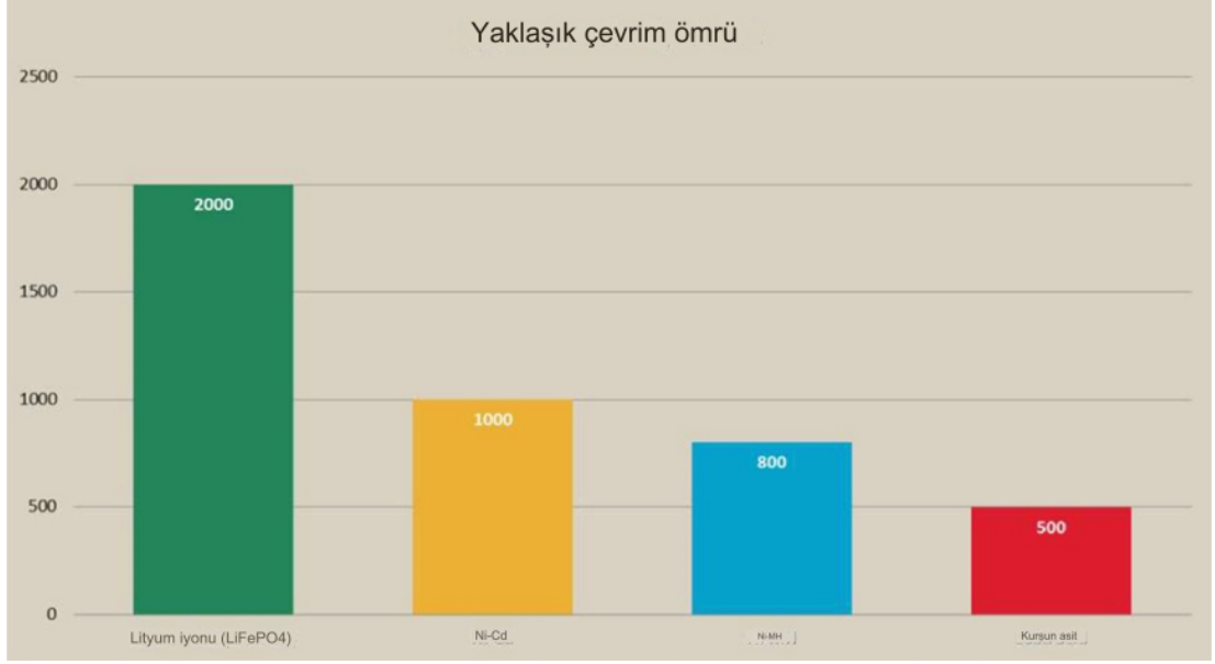
Şekil 1.8. Şarj edilebilir pillerin yaklaşık çevrim ömrü karşılaştırması (Hsu vd., 2024).
