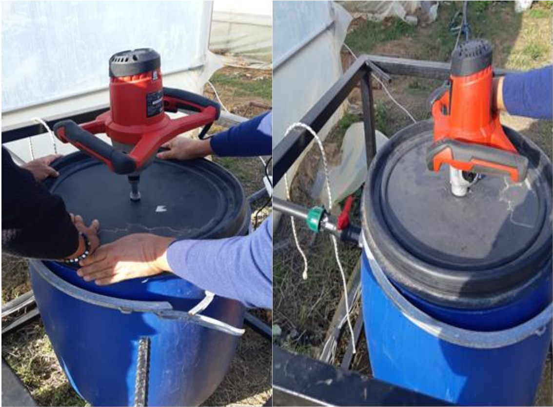
Şekil 3.19. Otomatik karıştırıcı ile kompost tanklarının karıştırılması
