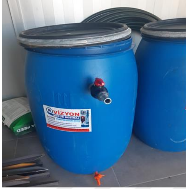
Şekil 3.17. Kompost tanklarının tahliye ve gaz çıkışı vanasına ait görsel
