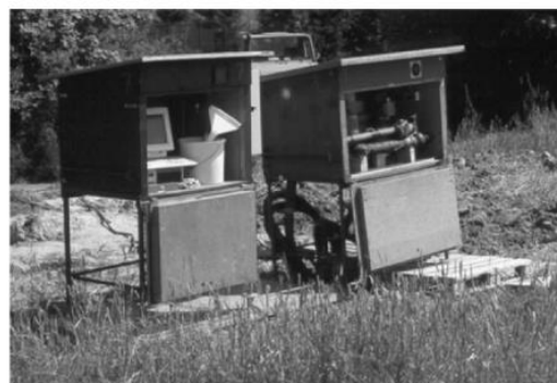
Figure A.4 : German thermal response test rig (Landtechnik Weihestephane). Photo: Landtechnik Weihestephane.
