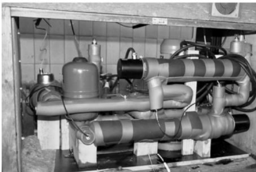
Figure A.4 : German thermal response test rig (Landtechnik Weihestephane). Photo: Landtechnik Weihestephane.
