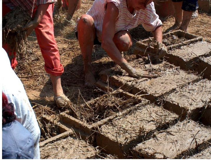
Şekil 4.30. Kerpiç tuğla üretim aşamaları (Soare, 2003)
