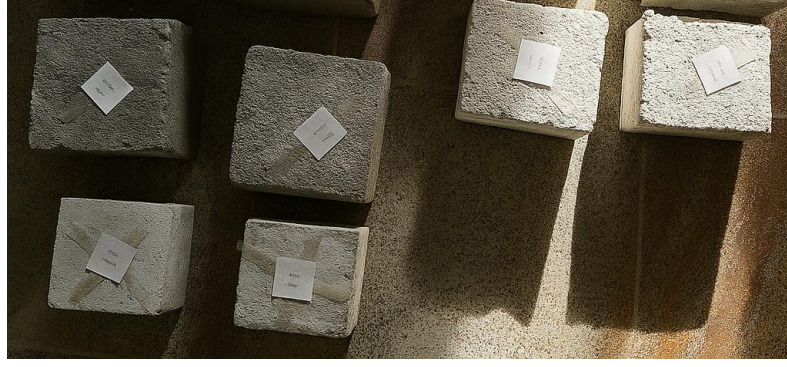
Şekil 22. 450°C sıcaklıkta 60 dakika boyunca test edilen sıvalı ve UNP numune grupları
