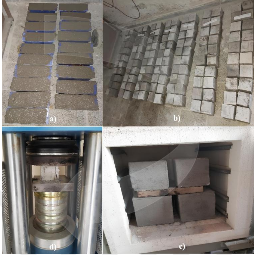
Şekil 10. a) Hazırlanmış harcın kalıba dökülmesiyle beton numunelerinin oluşturulması, b) Numunelerin belirlenen kalınlıkta pürüzlü sıva ile kaplanma aşaması, c) Numunelerin fırına yerleştirilerek, belirli sıcaklıklara maruz bırakılması, d) Fırınlamadan sonra, numunelerin basma dayanımı testine tabi tutulması
