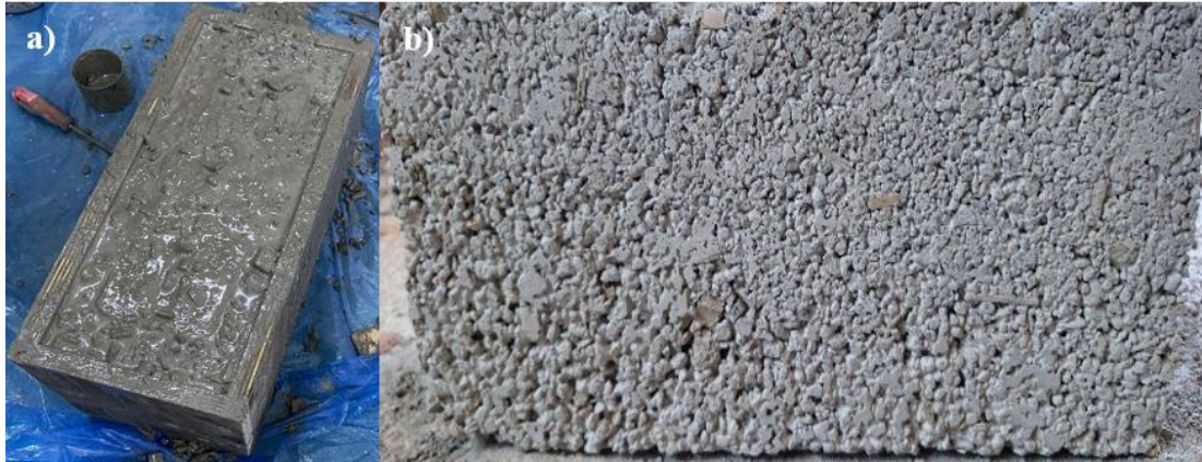
Şekil 13. a) Numunenin deneye hazırlanma aşamasındaki durumu, b) Numunenin deneye hazır olduğu anki durumu
