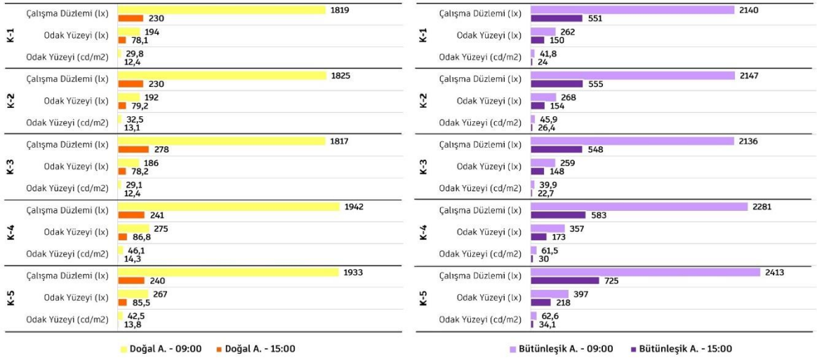
Şekil 41. Derslik 3’ün kombinasyonlara göre çalışma düzlemi ve odak yüzeyinde aydınlık düzeyi değerleri
