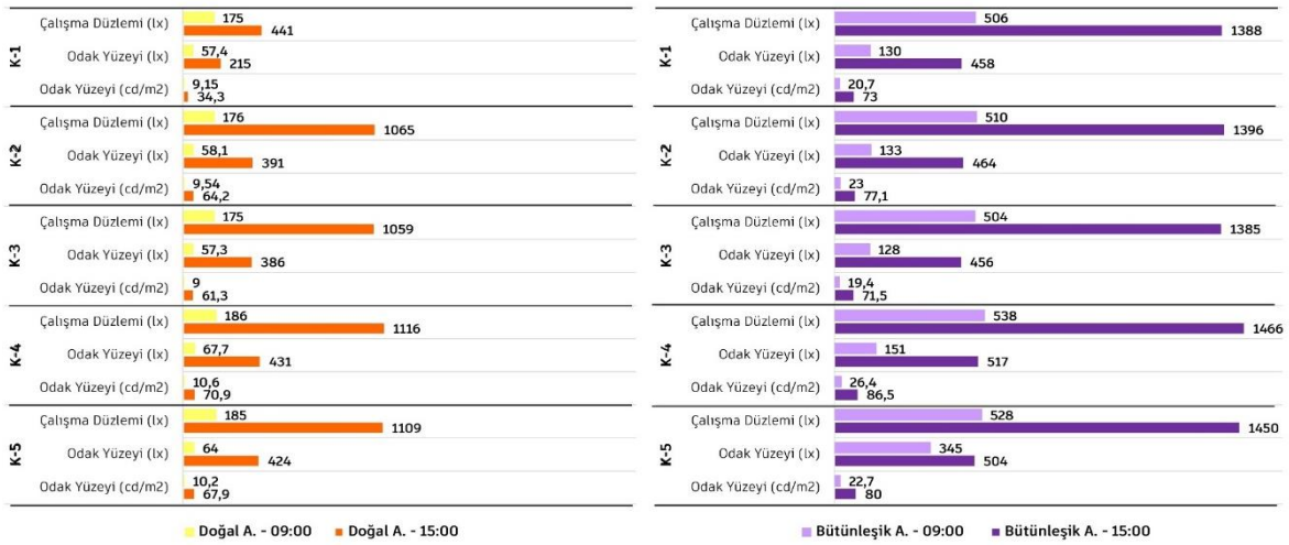
Şekil 49. Derslik 17'nin kombinasyonlara göre çalışma düzlemi ve odak yüzeyinde aydınlık düzeyi değerleri
