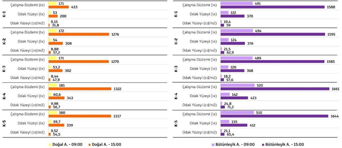
Şekil 50. Derslik 20'nin kombinasyonlara göre çalışma düzlemi ve odak yüzeyinde aydınlık düzeyi değerleri
