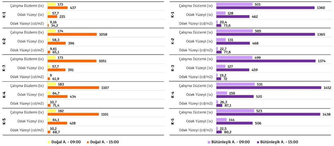
řekil 45. Derslik 10'un kombinasyonlara göre çalıřma düzlemi ve odak yüzeyinde aydınlık düzeyi değeri
