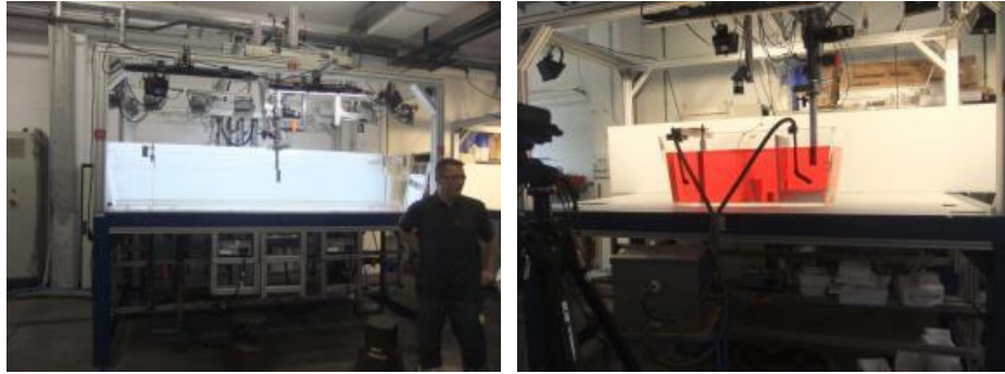
Şekil 4.4 : Tandiş su modellemesi deney düzeneği.
