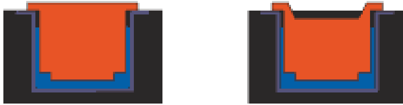
Şekil 3.4 : Hazelett Döküm Makinası ile Üretilmiş Bakır Anotların Elektroliz Hücreindeki Görüntüsü ( http://www.hazelett.com , tarih yok)
