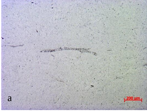
Şekil 6.2 : A Numunesi Döküm Yönüne Dik Kesit (T) Optik Mikroskop Görüntüleri a) 5x büyütme b) 20x büyütme c) 50x Büyütme
