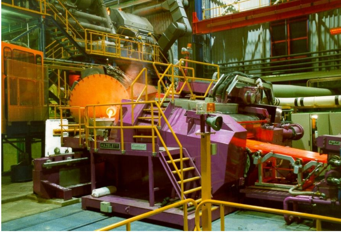
Şekil 3.2 : Hazelett Bakır Anot Döküm Makinası ( http://www.hazelett.com , tarih yok)
