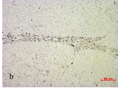
Şekil 6.2 : A Numunesi Döküm Yönüne Dik Kesit (T) Optik Mikroskop Görüntüleri a) 5x büyütme b) 20x büyütme c) 50x Büyütme
