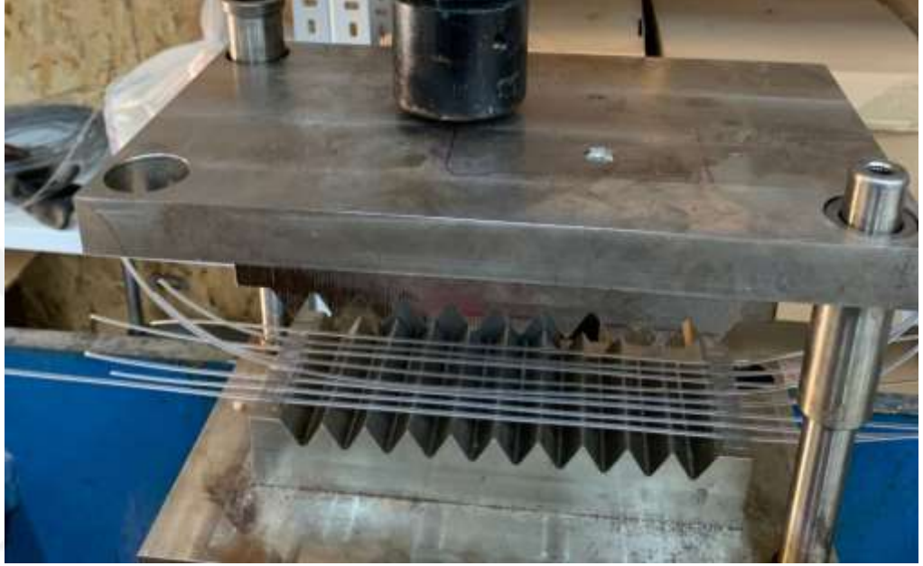
Şekil 3.9. Filamentlerin basılmadan önce gergin bir pozisyonda dizilmiş halde görüntüsü
