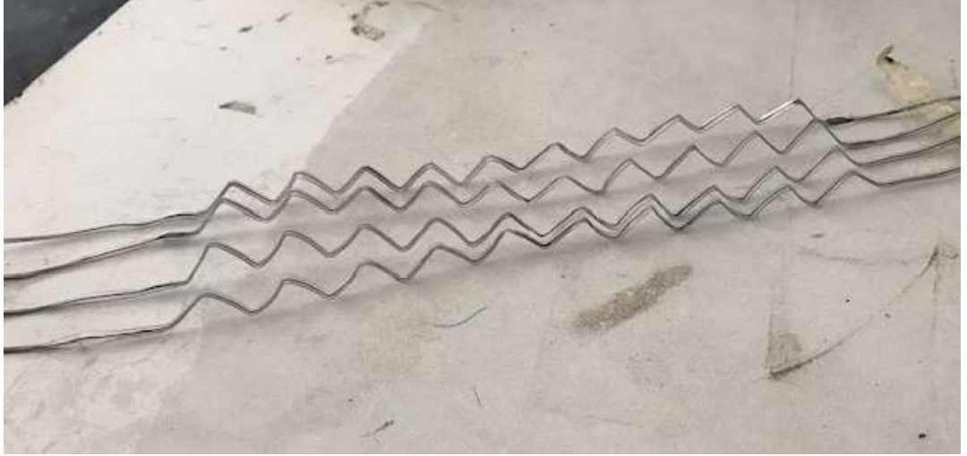
Şekil 3.11. Filamentlerin teflon cam kumaş arasında basılarak aldıkları görünüm
