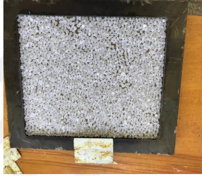
řekil 3.4. Kalıp ierisine serilmiř granöl polietilen
