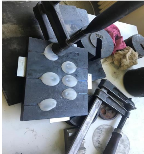
Şekil 3.7. Mengersiyle sıkıştırılmış kalıp içerisinde ki erimiş granüllerin soğutulması
