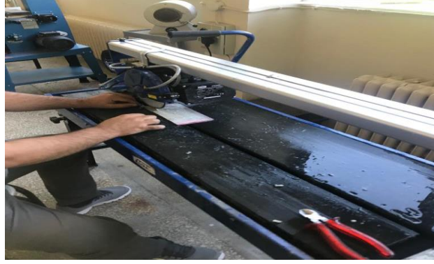
Şekil 3.13. Sulu mermer kesme makinesi ile deney numunesinin kesilmesi
