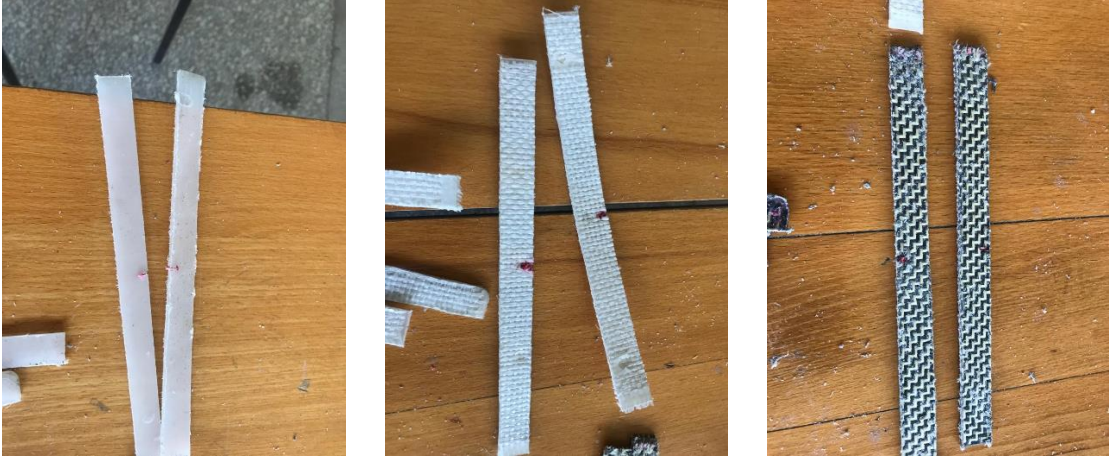
Şekil 3.15. Kıl testeresiyle çentik açılmış numuneler
