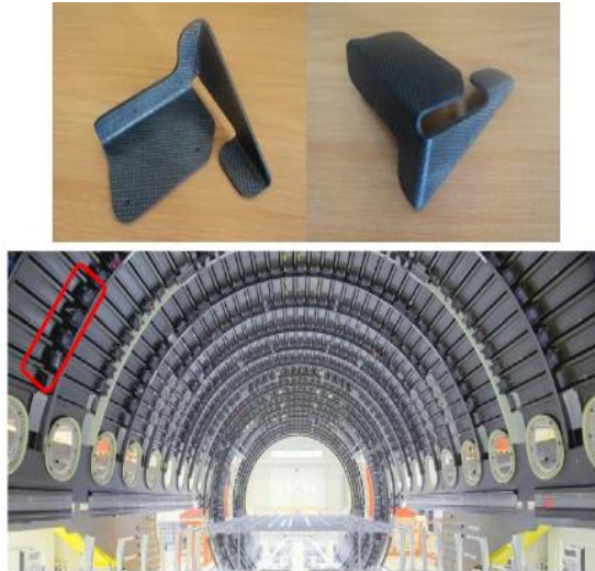
Şekil 2.10. A350XWB yolcu uçağı gövde klipleri [24].
