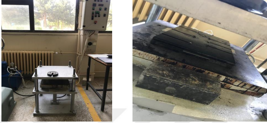
Şekil 3.6. Sıcaklık kontrollü fırına konulmuş kalıp
