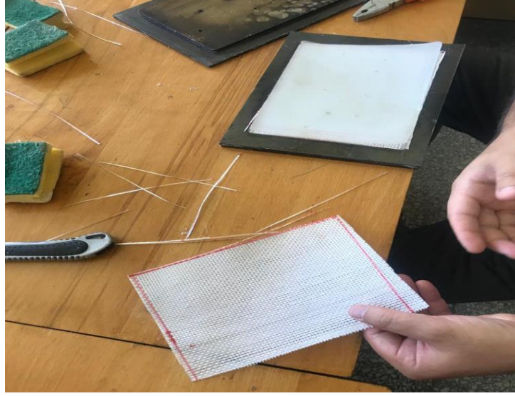
Şekil 3.11. Cam elyaf ile kompozit plak üretim aşama sıralaması
