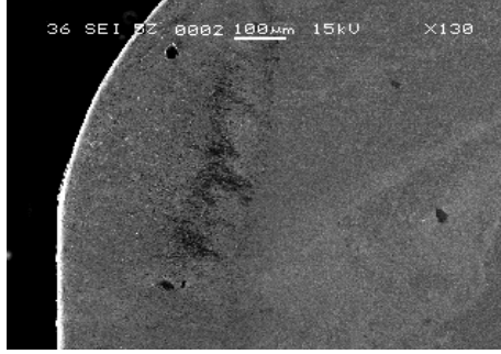
Şekil 5.46a Takım ucu talaş yüzeyinin 7.3+9.4sn süre sonunda SEM’de çekilmiş fotoğrafı.
