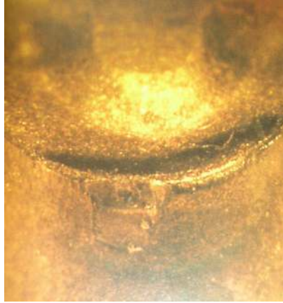
Şekil 4.2 Kesici takım talaş yüzeyinde oluşan enine çatlak fotoğrafı.
