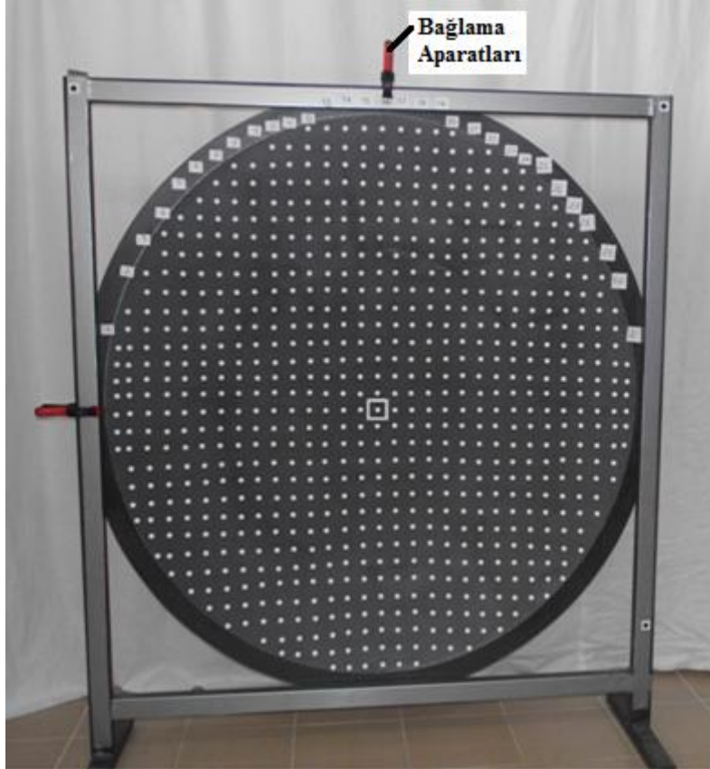
Şekil 3.40 Kontrol noktalarının 1/4 ölçekli reflektör üzerine yapıştırılması
