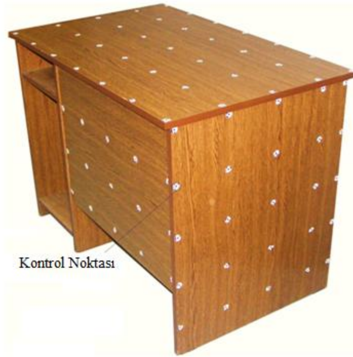
Şekil 3.12 Bilgisayar masasına yerleştirilen kontrol noktaları
