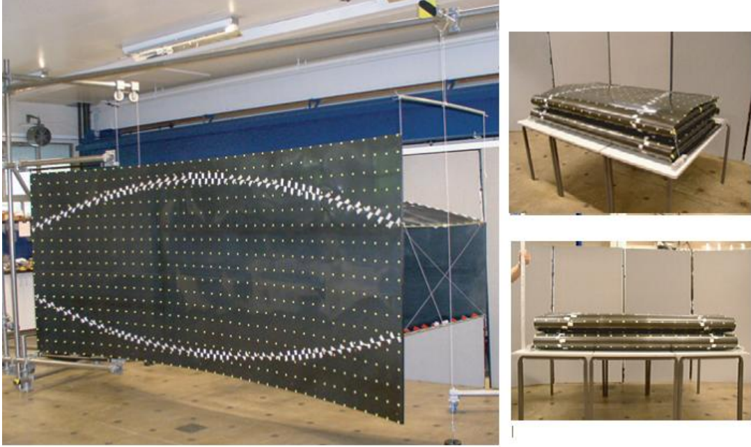
Şekil 2.7 Ölçekli olarak imal edilmiş kabuk yüzeyli reflektör ve katlanmış hali (Soykasap and Pellegrino 2004).
