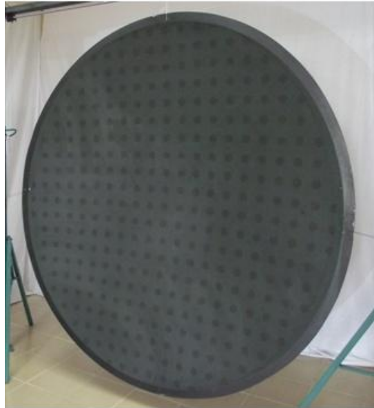
Şekil 3.20. Kontrol noktalarının reflektör üzerine yansıtılması
