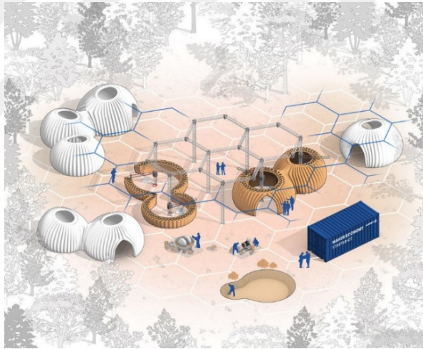
Şekil 2.21. 3B yazıcı için şantiyeyi hazırlanma ve kalıp montajı süreci [19].
