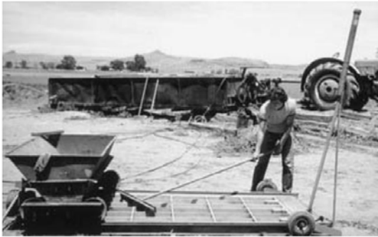
Şekil 2.11. Huni ile doldurulan ahşap kalıplar [18].
