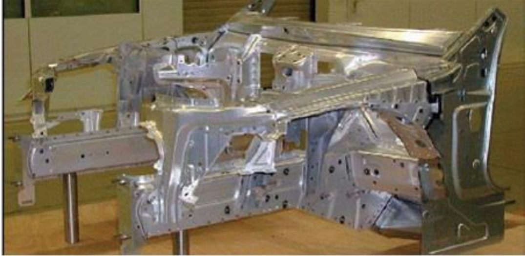
Şekil 2.4. Audi A3 için Al levhadan üretilmiş ön bölüm
