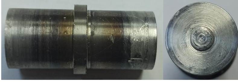
Resim 6.6. AA6061-AA7075 plaka çiftlerinin birleştirilmesi esnasında aşınan bir takım
