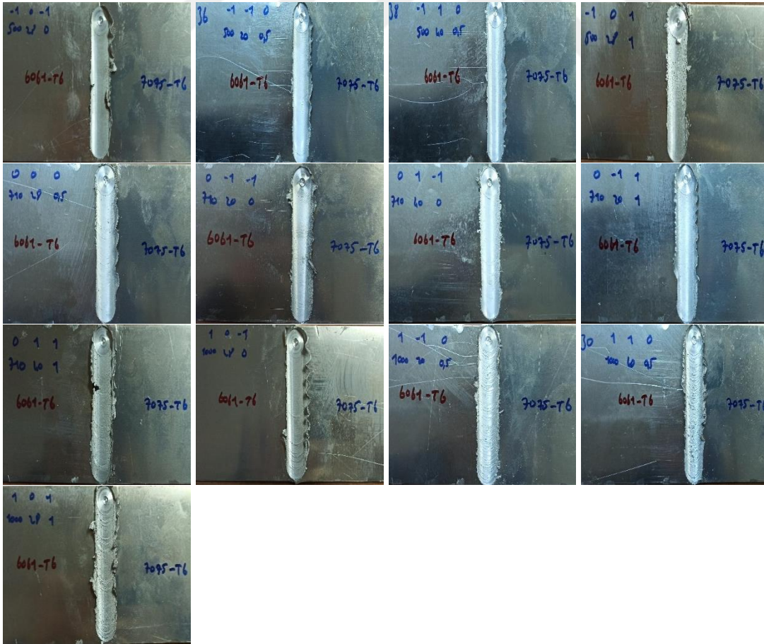
Resim 6.7. AA6061-AA7075 plakalar kullanılarak birleştirilmiş yeni plakalar
