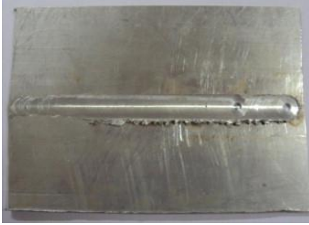
Resim 3.11. Tandem çiftli takım uygulaması ile kaynaklanmış 2,5mm plaka [76]
