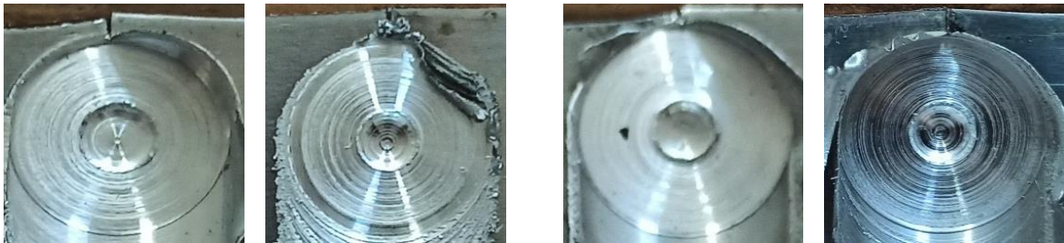
a) 710 dev/dak, 40 mm/dak, 0° b) 710 dev/dak, 40 mm/dak, 1° c) 500 dev/dak, 28 mm/dak, 0° d) 500 dev/dak, 28 mm/dak, 1°
