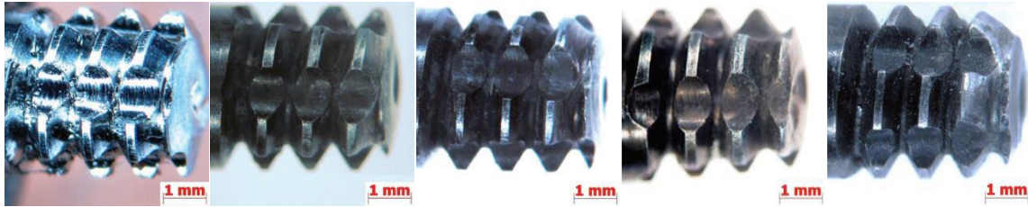
Resim 3.16. Sürtünme karıştırma kaynağında kaynak uzunluğunun takım aşınmasına etkisi. (Kaynak uzunlukları ve aşınma oranları soldan sağa doğru; 0 m, 100 m & %2, 200 m & %4, 300 m & %10, 400 m & %12) [98]
