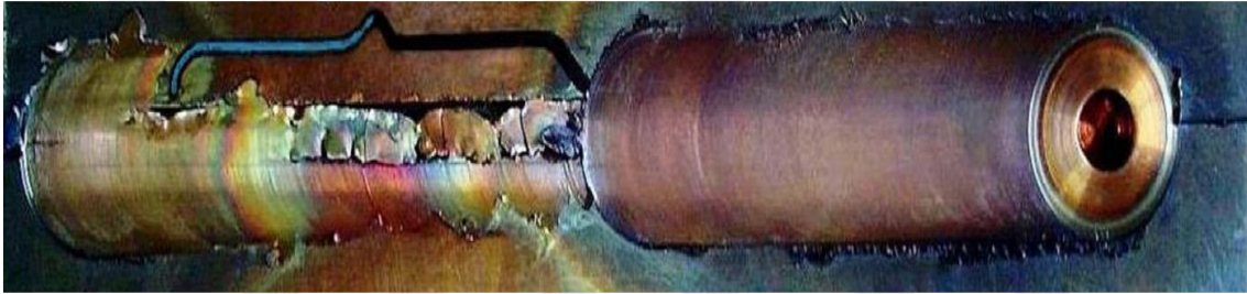
Resim 3.9. Bakır plakada farklı penetrasyon derinliklerinde kaynak yüzeyi görünümü. (İşlem parametreleri; dönme devri: 700 dev/dak, ilerleme hızı: 40 mm/dak, takım açısı: 1°) [70]
