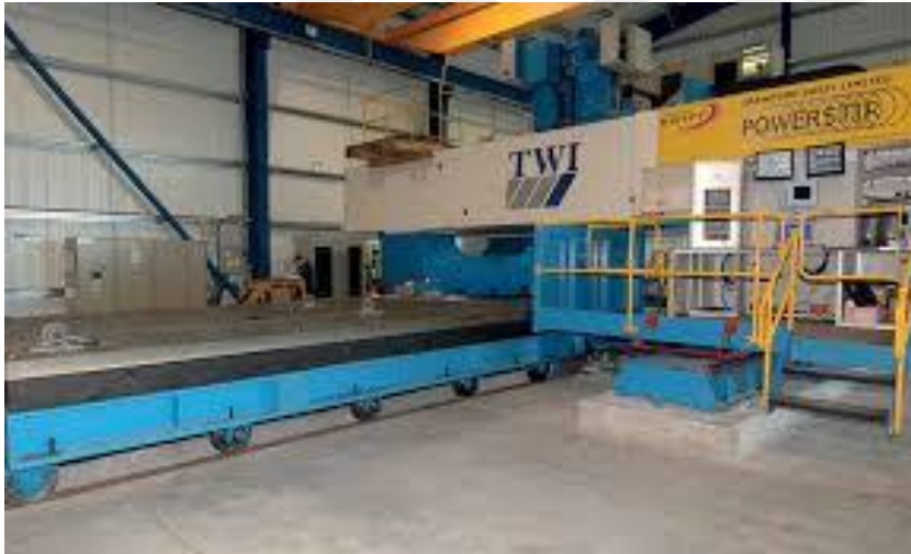
Resim 3.15. Crawford Swift Power Stir firmasına ait tek pasoda 150 mm kalınlıkta kaynak yapabilen FSW makinası
