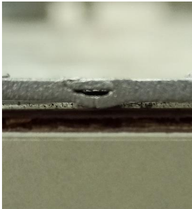
Resim 6.9. Kapalı tünel oluşumuna sahip kaynak kesiti
