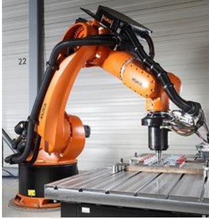
Resim 3.17. KUKA ve TWI tarafından geliştirilmiş robot FSW kol [99]
