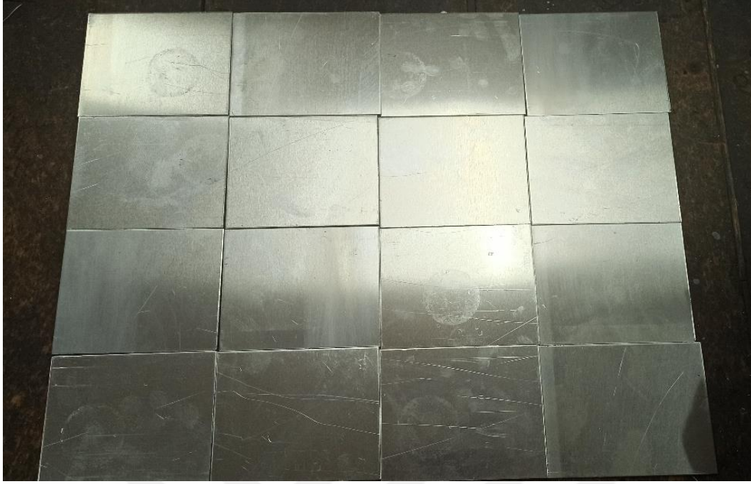
Resim 5.1. 100 mm × 125 mm × 2 mm boyutlarında kesilmiş AA6061-T6 plakalar
