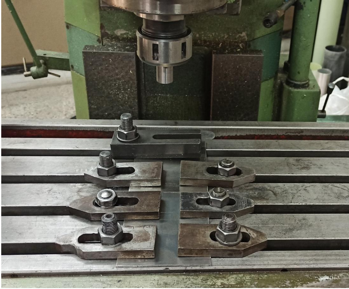
Resim 6.5. AA6061-AA7075 plaka çiftlerinin tezgâh tablasına yerleştirilmesi
